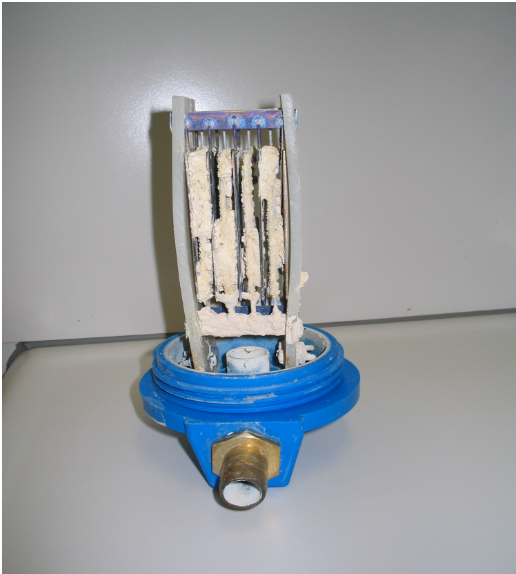
Abbildung 33: Elektroden des verblockten E-Disinfector der Firma NewTec
