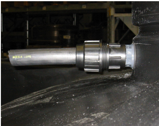
Abbildung 6: Anschluss des HDPE-Schlauches an den Behälter
