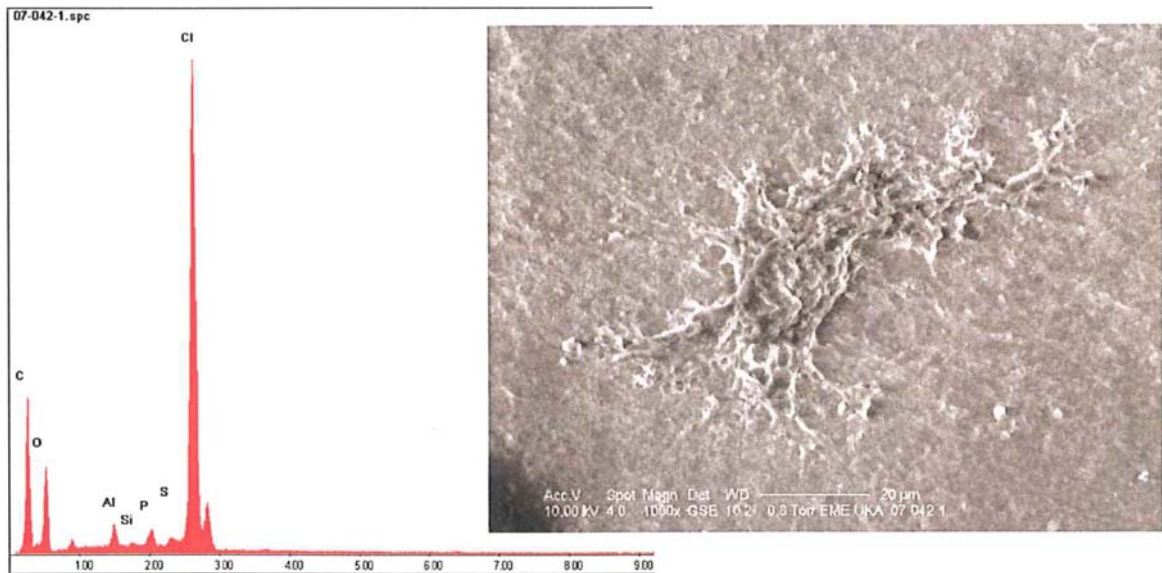
Bild 15: REM-Aufnahme der Membrandeckschicht der Mikrofiltrationsmembran (rechts, Balkenlänge 20 µm) und zugehöriges EDX-Spektrum (links) mit Zählrate (y-Achse) gegenüber eV (x-Achse)
