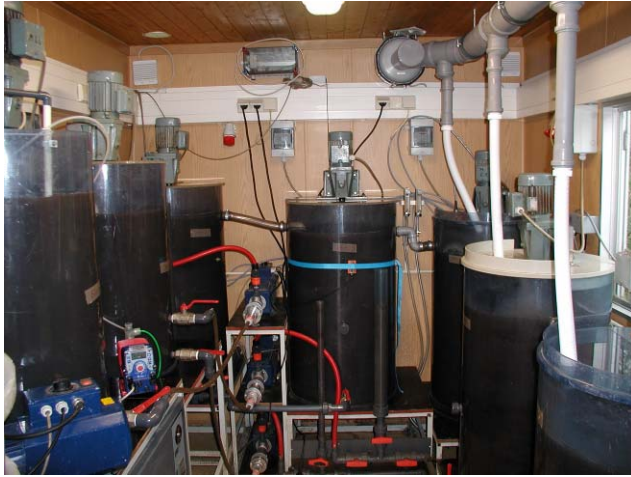
Abbildung 2.3: Versuchsanlage nach dem Bio-P- Verfahren
