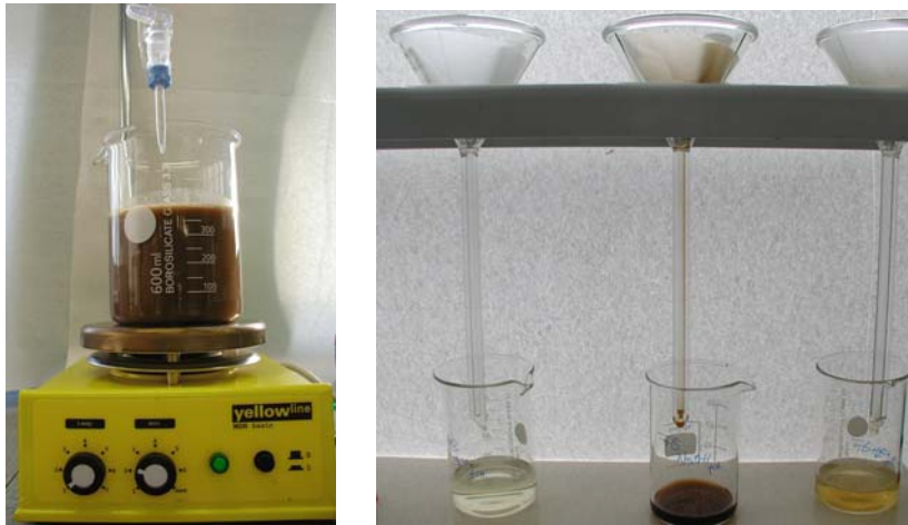
Abbildung 4.21: Säurezugabe und Filtration der mit Säure rückgelösten Schlammproben
