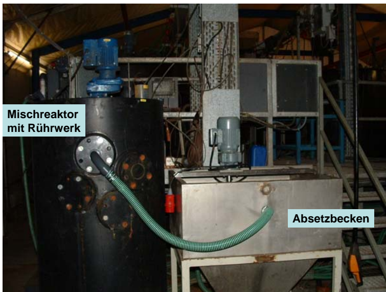
Bild 2.2: Mischreaktor mit Rührwerk und Absetzbecken der Nachfällungseinheit Bild 2.3: Fällmitteldosierung
