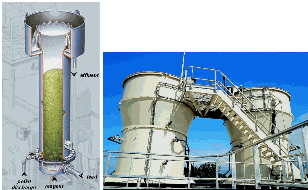
Bild 4.12: Prinzip des Crystalactor ® und Ansicht der Reaktoren in Geestmerambacht (GIESEN und DE BOER, 2003)
