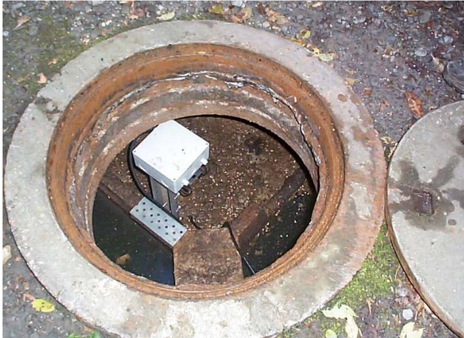
Bild 9: Prototyp eines Schlammspiegelmesssystems in einer Kleinkläranlage
