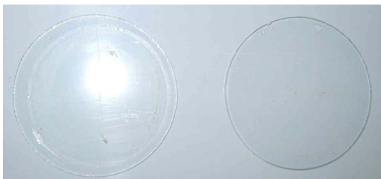
Bild 17: Glasscheiben mit Beschichtung nach 43 Tagen im Einsatz
