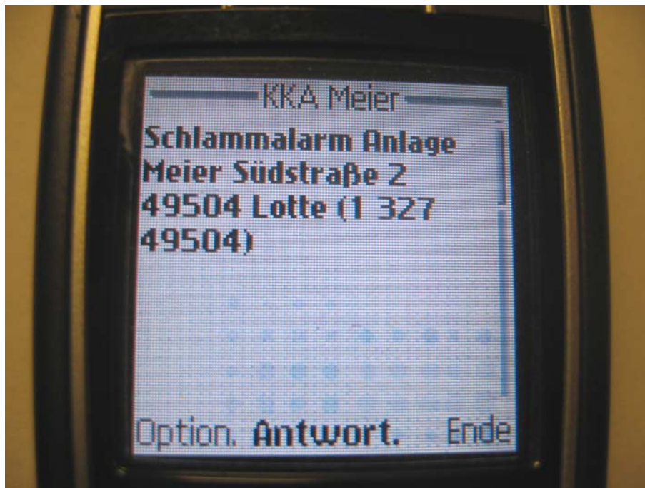
Bild 22: Schlammalarmmeldung per SMS
