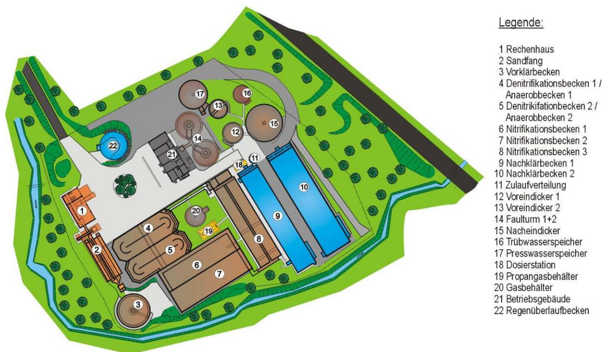
Bild 9.1: Schema der Kläranlage Büchel (Aggerverband)
