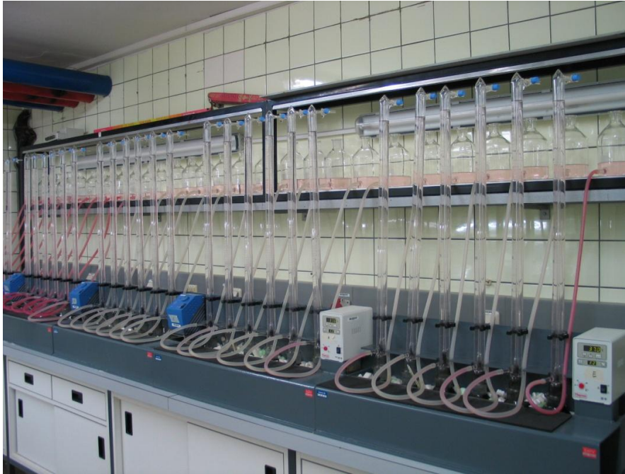
Abbildung 13: Versuchsanlage zum anaeroben Batchversuch zur Prüfung des Desorptionsverhaltens von Spurenstoffen im anaeroben Milieu
