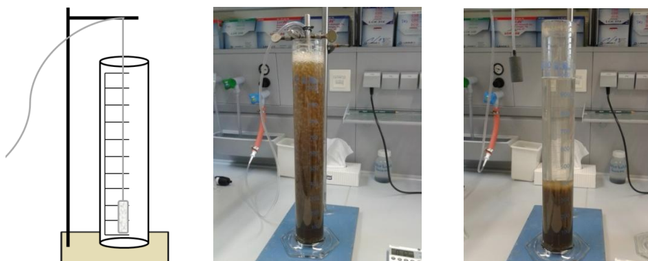
Abbildung 2: links: Versuchsaufbau PAK-Dosierversuche mit Belebtschlamm des Klärwerkes Düsseldorf-Süd, Mitte: Belüftungsphase, rechts: Absetzphase während der Versuchsdurchführung
