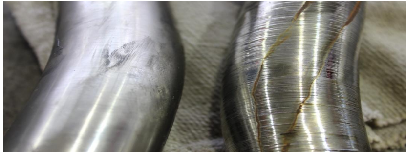
Abbildung 9: Ausgebaute Rotoren der Rücklaufschlammumpen der halbtechnischen Versuchsanlage. Links: Rotor der Referenzstraße ohne sichtbare Verschleißerscheinungen. Rechts: Rotor der Teststraße mit deutlichen Abrasionsspuren
