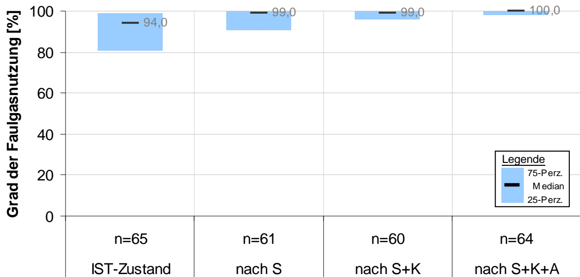
Bild 4.7: Grad der Faulgasnutzung vor und nach Umsetzung der Maßnahmen
