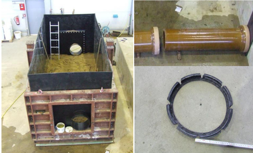
Abb. 10: Abgedichteter Versuchsstand (links), Dichttring mit Fehlstellen (rechts unten), gekürztes Steinzeugrohr (rechts oben)
