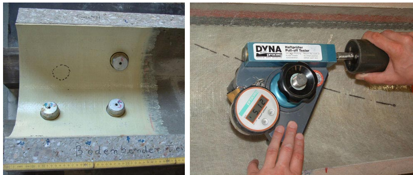
Abb. 12: Bohrungen mit aufgeklebten Prüfstempeln (links) und Haftzugprüfgerät während der Prüfung (rechts)
