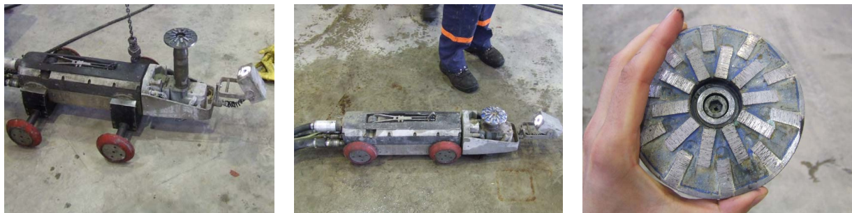
Abb. 41: Fräsroboter für DN 600 mit Pilzkopffräser (links), Fräsroboter für DN 300 mit Pilzkopffräser (mittig), Pilzkopffräser (rechts)
