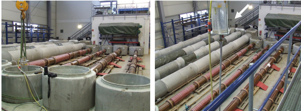
Abb. 7: Bildbeispiel Dichtheitsprüfung mit Freispiegelbehälter auf 0,5 m und 5 m Höhe über Rohrscheitel
