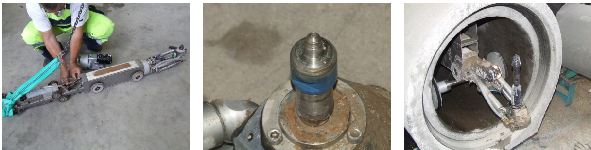
Abb. 20: Fräsroboter DN 200 mit Kegelfräskopf (links), Fingerfräskopf (mittig), Fräsroboter DN 600 mit Kegelfräskopf (rechts)
