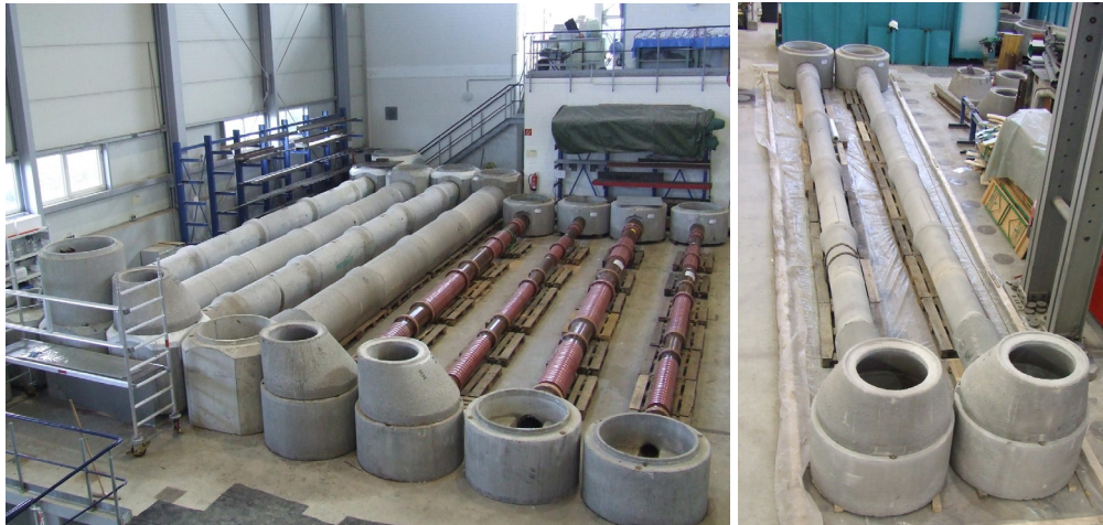
Abb. 4: Teststreckenaufbau für die Innenmanschetten und Kurzliner
