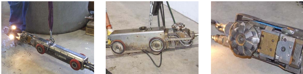
Abb. 28: Fräsroboter für Nennweite DN 200 (links), Fräsroboter für Nennweite DN 300 (mittig), Fräskopf „Pilzkopffräser“ (rechts)
