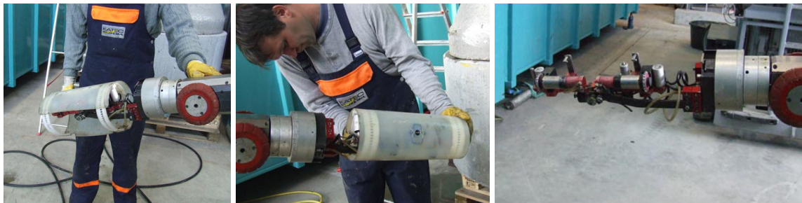
Abb. 24: Setzgerät mit Schalungsmanschette (links u. mittig) und Schalungssetzgerät-Vorbau des Roboters (rechts)
