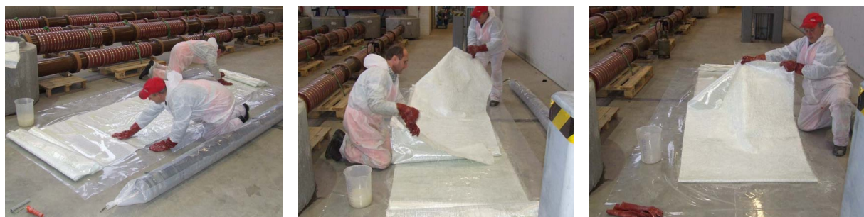
Abb. 39: Händisches Auftragen des Harzes (II), Auflegen der dritten Gewebelage (mi), Einschlagen des harzgetränkten Gewebes zur Mitte hin (re)
