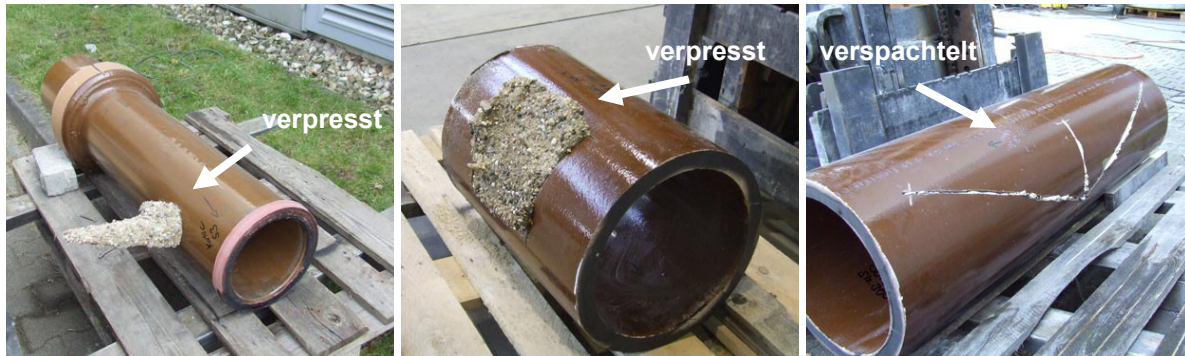
Abb. 27: Bildbeispiel – Detail Rohraußenseite Stz. DN 200 (links) und DN 300 (mittig, rechts)
