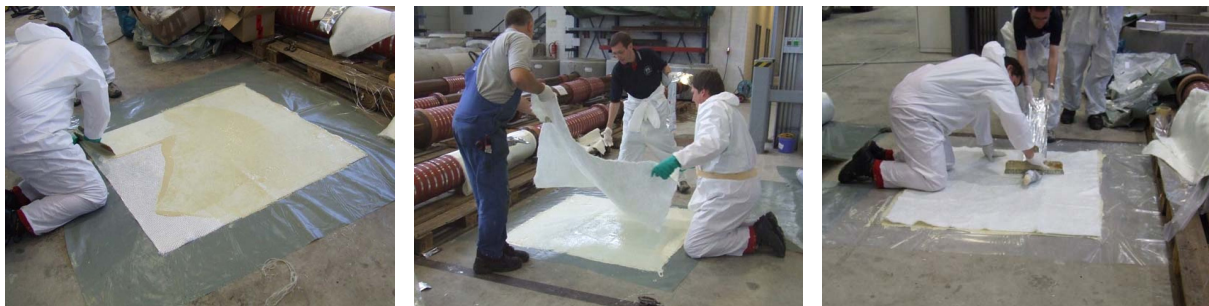
Abb. 44: Auftragen des Harzes auf das Glasfasergewebe (links), Einlegen der Polyestervlies-Kombimatte (mittig), Auftragen des Harzes auf die Polyestervlies-Kombimatte ( rechts)
