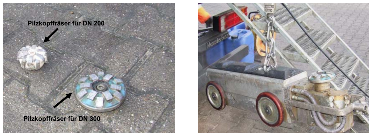
Abb. 38: Verwendete Fräsköpfe: „Pilzkopffräser“ (links), Fräsroboter für Nennweite DN 300 (rechts)
