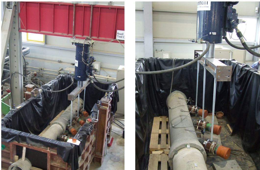
Abbildung 5: Hutprofile mit Lasteinleitungskonstruktion (hier 45°-Stützen)
