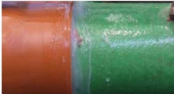
Abbildung 3: Gerissenes Gummi-Hutprofil am Stutzen Nr.3 (li) und Poren im Pyrolus-Material beim Stutzen Nr.2 (re)
