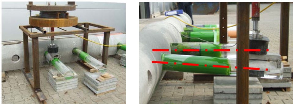
Abbildung 4: Versuchsaufbau der Vorversuche [1] : Vertikalbelastung bei Auflagerung des Anschlusskanals (li) und Abwinklung der Anschlusskanäle bei entfernter Auflagerung (re)
