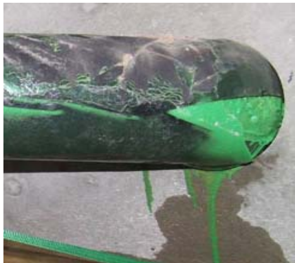
Abbildung 3: Gerissenes Gummi-Hutprofil am Stutzen Nr.3 (li) und Poren im Pyrolus-Material beim Stutzen Nr.2 (re)
