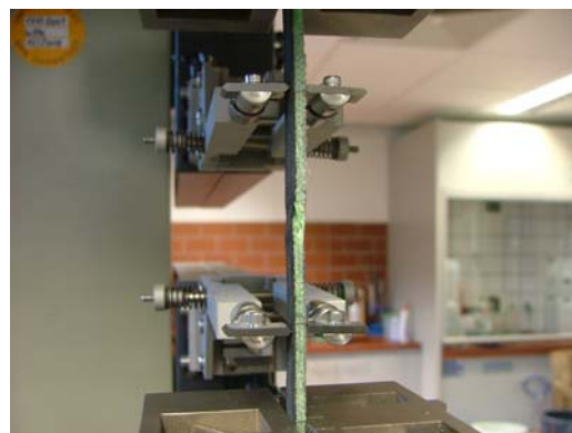
Abbildung 8: Probe im Dreipunkt-Biegeversuch (li) und Probe im Zugversuch (re)
