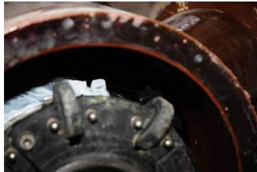
Abb. 52: Unbehandelte Klempe des Gummihutprofil 2 im Trockenversuch zu groß, deshalb Faltung beim Andrücken an den Abzweig
