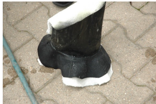
Abb. 17: Gummihutprofil nach dem Inversionsversuch
