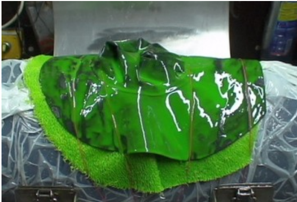
Abb. 106: V19, Hutkrempe aus 1,4 mm starkem Material, Harz als Gleitmittel und zur späteren Verklebung, Krempe an die Ellipsenform angepasst
