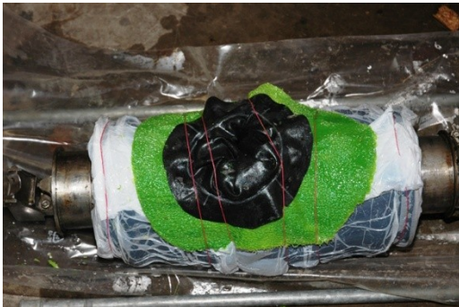
Abb. 64: Überdeckung von BRAWOLINER®-Hutprofil und Gummihutprofil, Gummihutprofil 0,8 mm stark und 90° zur Krempe ausgerichtet
