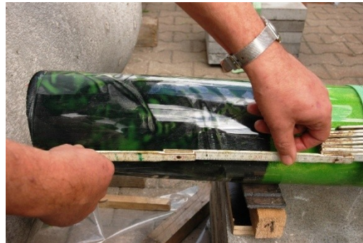
Abb. 33: Faltenbildung am Hutzyylinder des invertierten Gummiprofils
