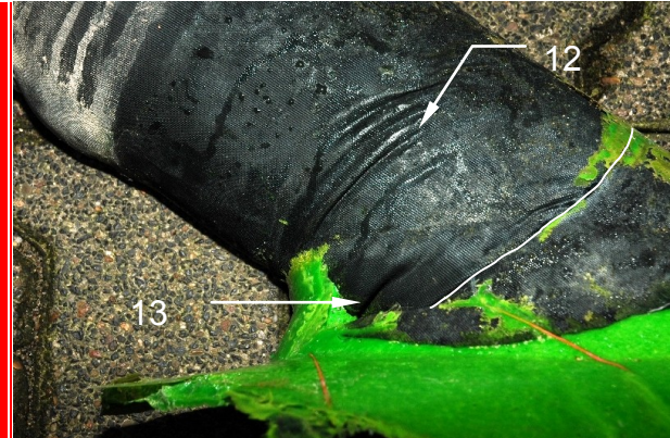
Abb. 89: V14, Schnitt 2, Verlauf der Verbindungsstelle von Krempe und Hut, 12-Faltenbildung im spitzen Winkel hervorgerufen durch Abwinklung des 90°-Gummihutprofils auf 45°, 13-extreme Faltung unmittelbar im spitzen Winkel
