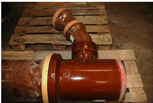
Abb. 49: 90° Abzweig mit anschließend verlegten 30°- und 15°-Bogen
