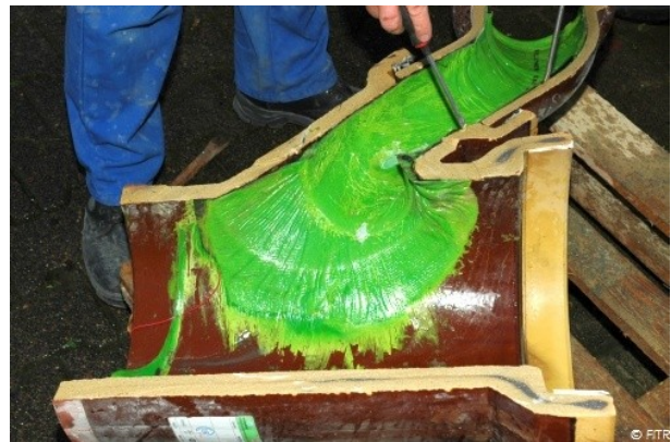
Abb. 109: V19, Schnitt durch den 45°-Abzweig, Ablösen des Gummihutprofils mit geringem Kraftaufwand möglich
