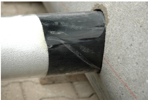
Abb. 16: Gummihutprofil nach dem Inversionsvorgang einschließlich Faltenbildung
