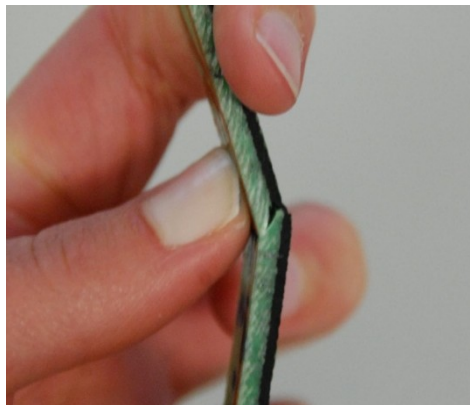
Abb. 140: Durch Zugbeanspruchung angerissener BRAWOLINER® mit Gummimaterial
