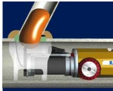
Abb. 5: KA-TE Schalungsmanschette mit eingestülptem Ballon [12]
