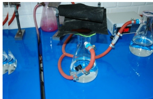
Abb. 37: Probe und Wasserglas nach Beendigung der APS-Dichtheitsprüfung an der Materialprobe mit Rhodamin
