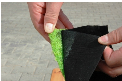
Abb. 36: Zugversuch zur Untersuchung des Haftverbundes von Gummimaterial und harzgetränktem BRAWOLINER®-Material
