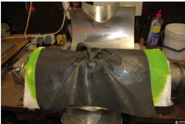
Abb. 92: V18, BRAWOLINER®-Hutprofil und Gummihutprofil vor dem Zuschnitt auf dem verlängerten Setzgerät
