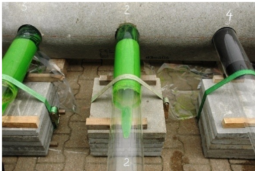
Abb. 20: Gummihutprofil und BRAWOLINER®-Hutprofil nach der Aushärtung
