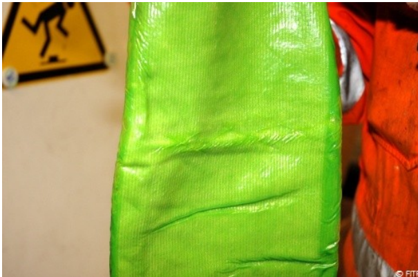
Abb. 116: V20, Ergebnis des Versuches nach dem Einwalken des Harzes in das BRAWOLINER®-Hutprofil
