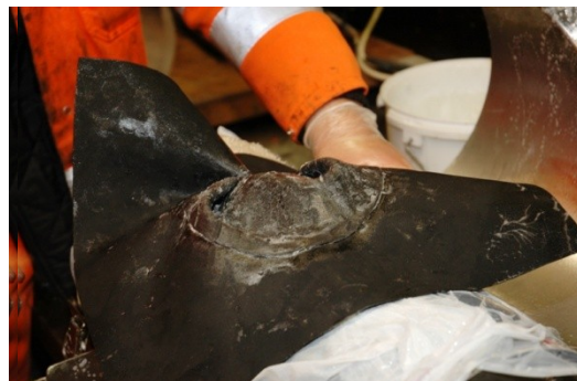
Abb. 50: Gummihutprofil am Ende des Einziehvorgangs bei V9
