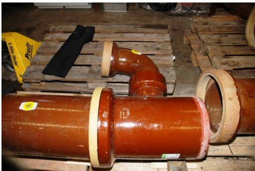
Abb. 60: Versuchsanordnung mit 90°-Abzweig und unmittelbar anschließendem 90°-Bogen
