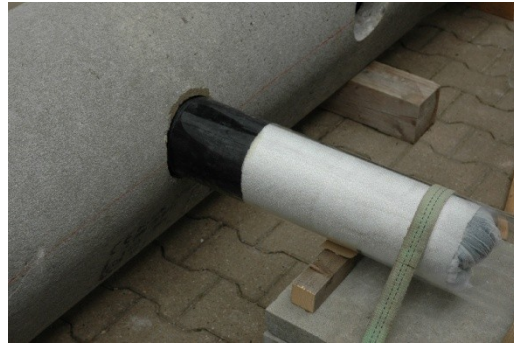
Abb. 15: Erfolgreiches Invertieren von BRAWOLINER®-Hutprofil und Gummihutprofil als Folge der vorgenommenen Änderungen
