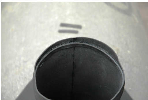
Abb. 21: Quellband am Hutzyylinder vor dem Inversionsvorgang
