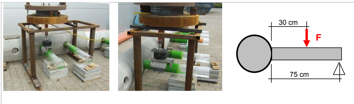
Abb. 39: Versuchsaufbau für die Scherlastversuche
