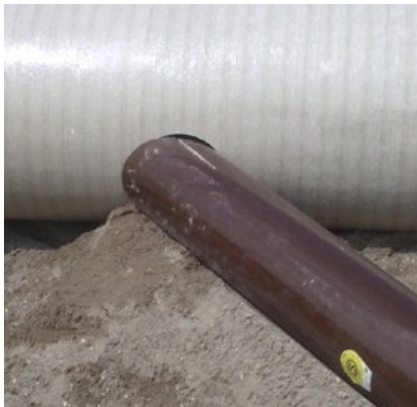
Abb. 146: Extremschaden für Hutprofilverfahren, Außenansicht vor Einbau [13]
