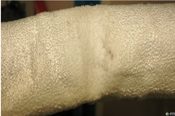
Abb. 114: V20, mit Melkfett über den gesamten Umfang behandelter Abschnitt des BRAWOLINER®-Hutprofils vor der Tränkung mit Harz
