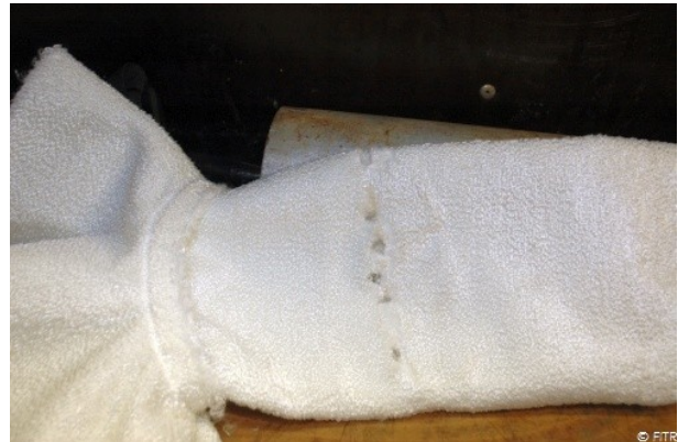
Abb. 117: V21, vor dem Einharzen in das BRAWOLINER®-Hutprofil geschnittene Löcher
