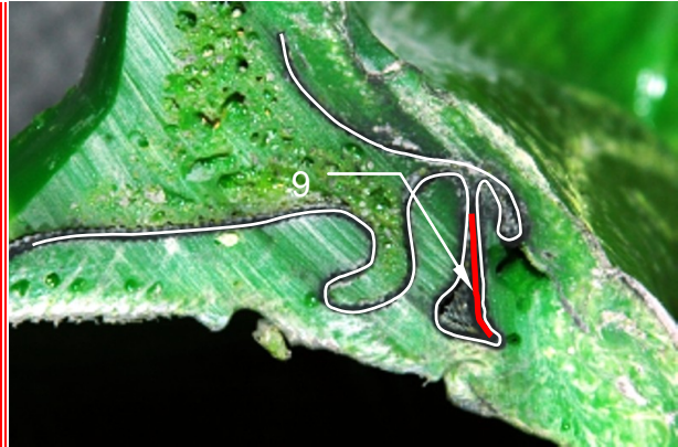
Abb. 83: V17, Schnitt 2, Verlauf der Faltung, 9-Überlappung durch Vulkanisierung
