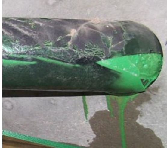
Abb. 128: Im Ergebnis des Inversionsvorganges gerissenes Gummihutprofil am Einlauf Nr. 3
