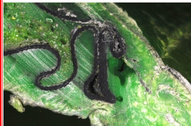
Abb. 81: V17, Schnitt 2, Faltung Gummihutprofil Detail
