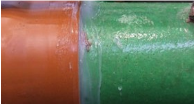
Abb. 129: Poren im BRAWOLINER®-Hutprofil des Stutzens Nr. 2
