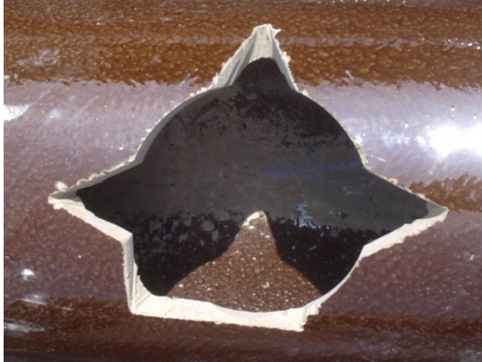
Abb. 144: Standardschaden für Hutprofilverfahren, Außenansicht vor dem Einbau [13]
