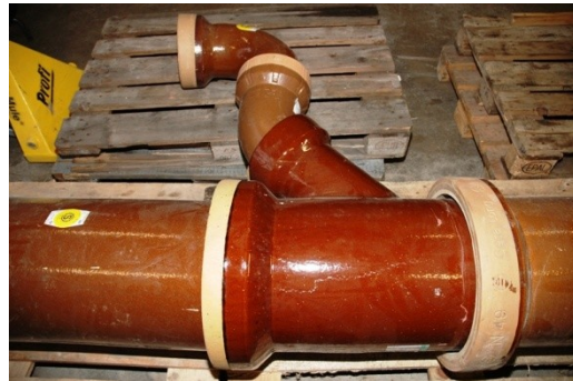
Abb. 48: 45° Abzweig mit anschließend verlegten 45°- und 90°-Bogen
