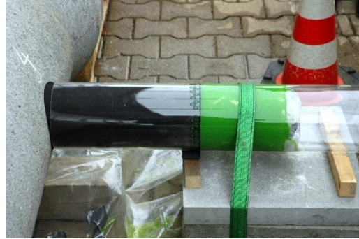
Abb. 30: Gummihutprofil und BRAWOLINER®-Hutprofil während der Aushärtung
