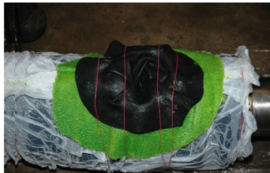
Abb. 61: Beim 90°-Gummihutprofil ist die Überdeckung des BRAWOLINER®-Hutprofils nach dem Einziehen in das Setzgerät größer, allerdings immer noch nicht optimal
