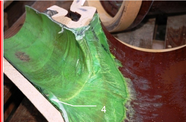
Abb. 77: V17, Schnitt 2, 4-Ende der Gummihutkrempe
