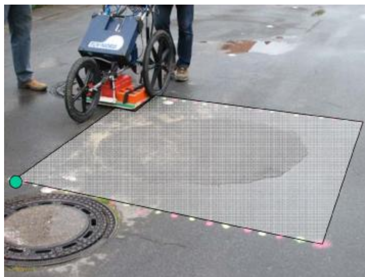
Abbildung 6: Georadarmessung: Messraster der Messlinien (Endom, 2007)
