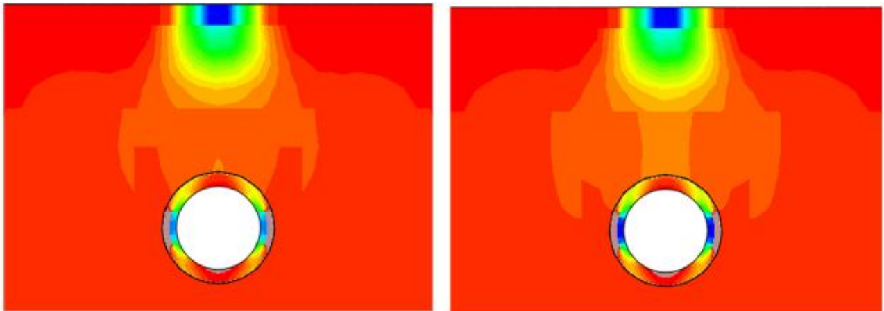
Abbildung 39: Spannungsverteilung der Vertikalspannungen im Modell 1 (Links: E_{\text{Asphalt}} = 10.000 \text{ N/mm}^2 ; Rechts: E_{\text{Asphalt}} = 1.000 \text{ N/mm}^2 )
