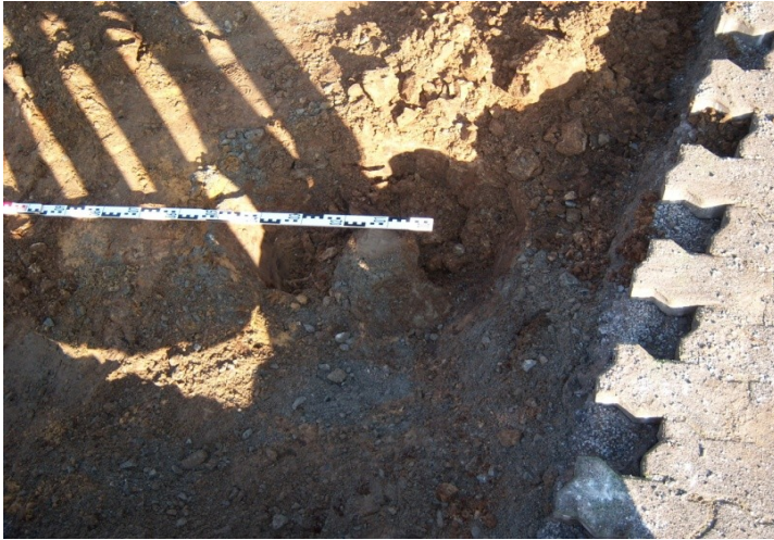
Spitze des Injektionskörpers (IP2)
