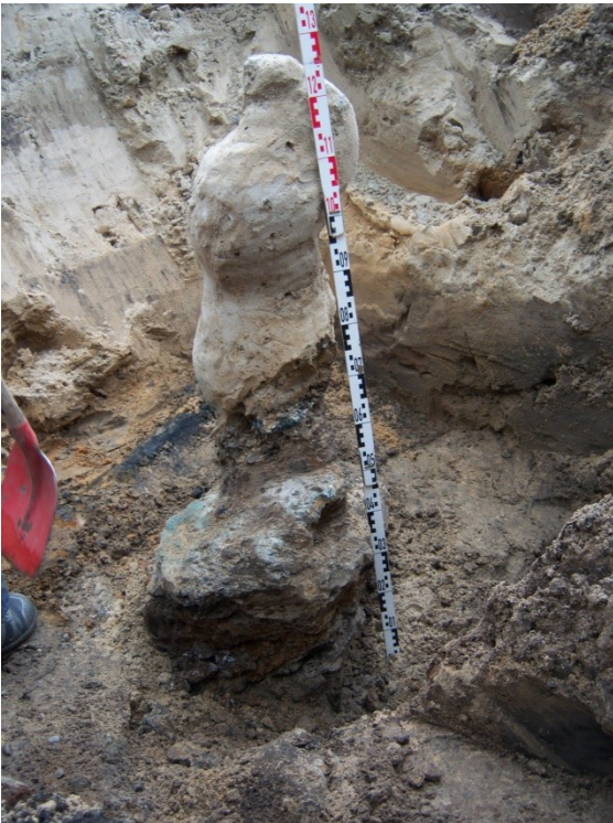
Freigelegter Injektionskörper (IP5)
