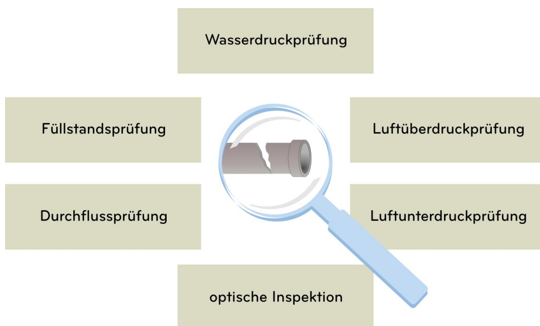
Abb. II-8: Verfahren zur Dichtheitsprüfung
