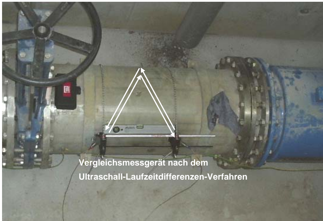
Bild 3.6: USD-Messung (Aufbau als V-Durchschallung)
