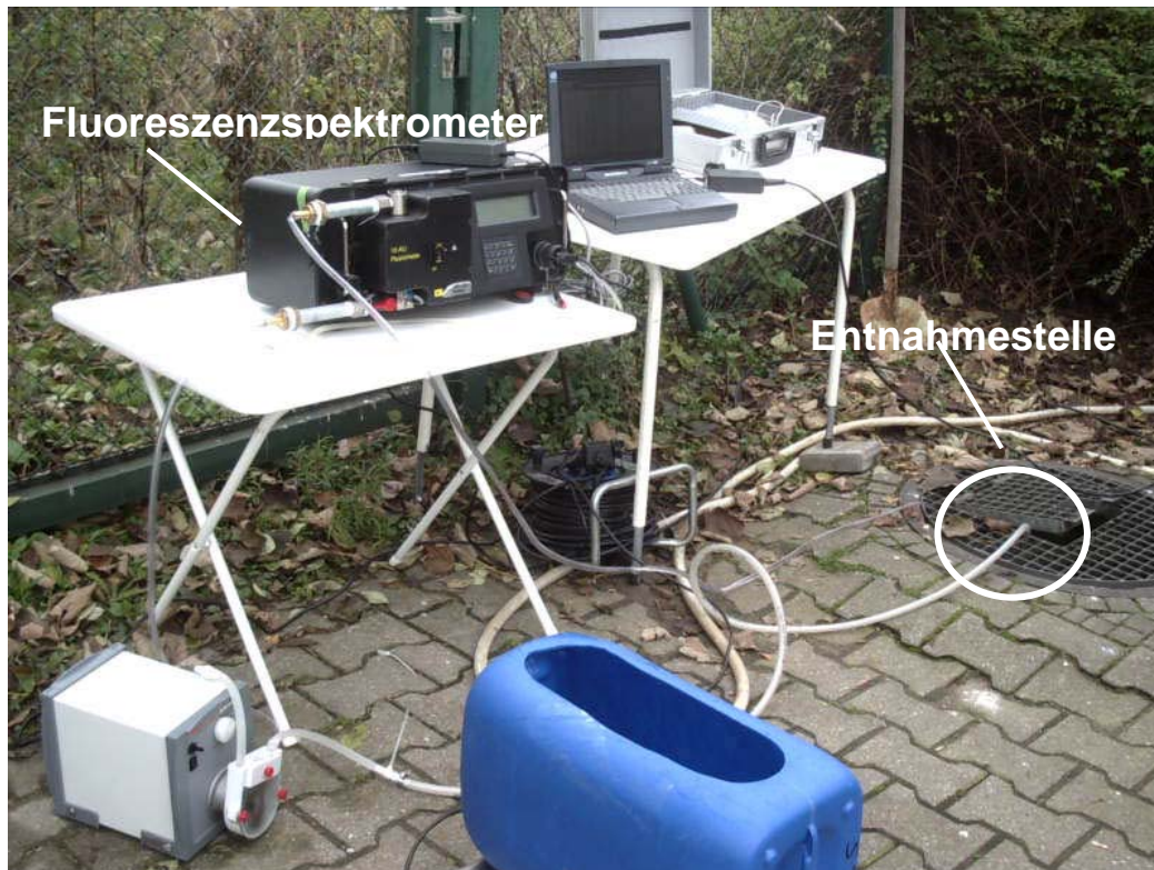
Bild 3.9: Entnahme und Analyse der Proben zur Bestimmung der Abflussmenge mittels Fluoreszenzspektrometrie im Ablauf einer Kläranlage
