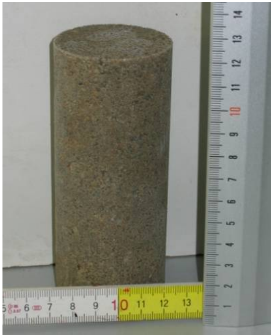
Bild 5-15 Gefrorene Probe aus Rheinsand
