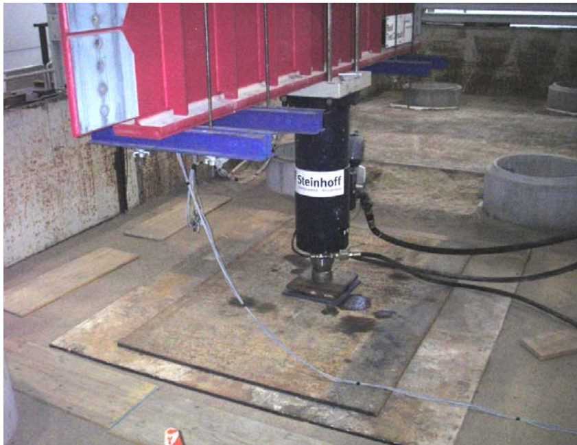
Bild 3-12 Lasteinleitungsstruktur für die Lastfälle „Einzelrad statisch“ und „Einzelrad lastzyklisch“
