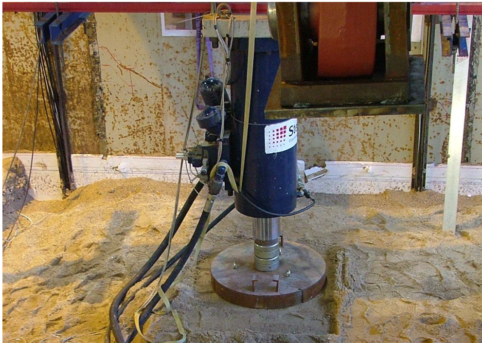
Bild 3-15 Lasteinleitungskonstruktion beim Lastfall „Einzelrad statisch - Bauzustand“
