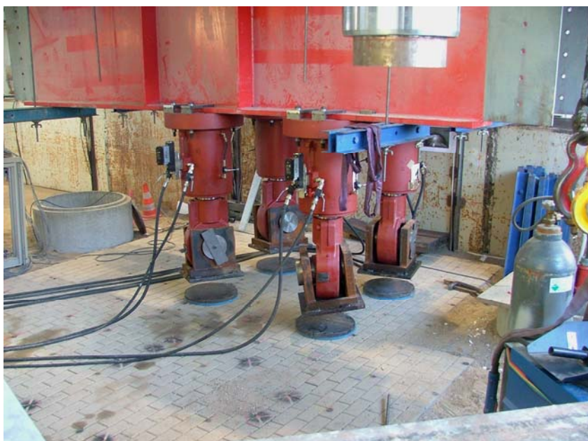
Bild 3-13 Lasteinleitungsstruktur für den Lastfall „Radgruppe statisch“
