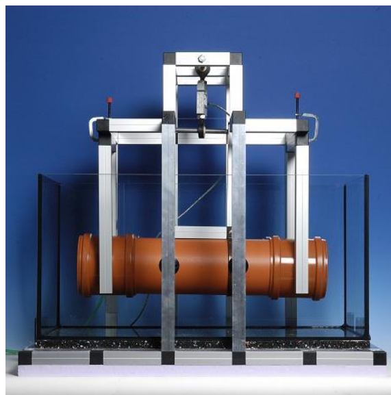
BILD 3: VERSUCHSANORDNUNG ZUR MESSUNG DER AUFTRIEBSWIRKUNG IM LABOR
