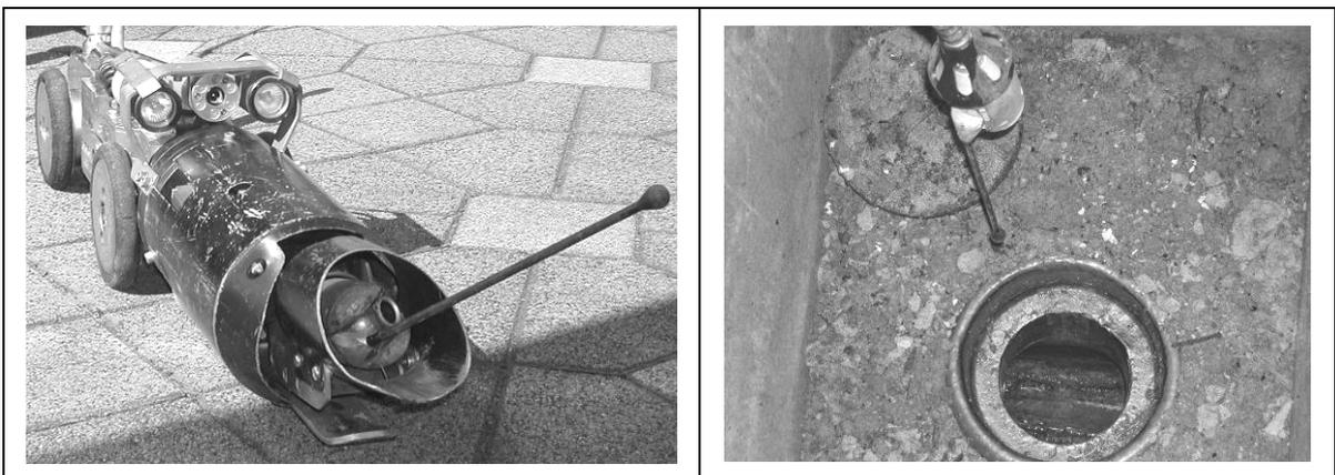
**Bild 2.2: IBAK ORION L und geöffnete Revisionsöffnung zur Inspektion**
