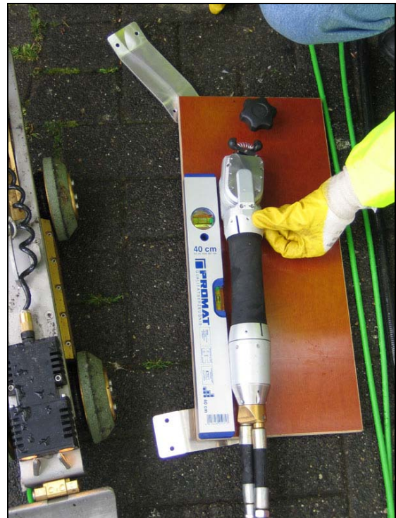
Abb. 25:Horizontale Ausrichtung der Lindauer Mini-Schere zur Kalibrierung des unterirdischen Ortungs- und Kanalverlaufsmeßsystems ASYS.
