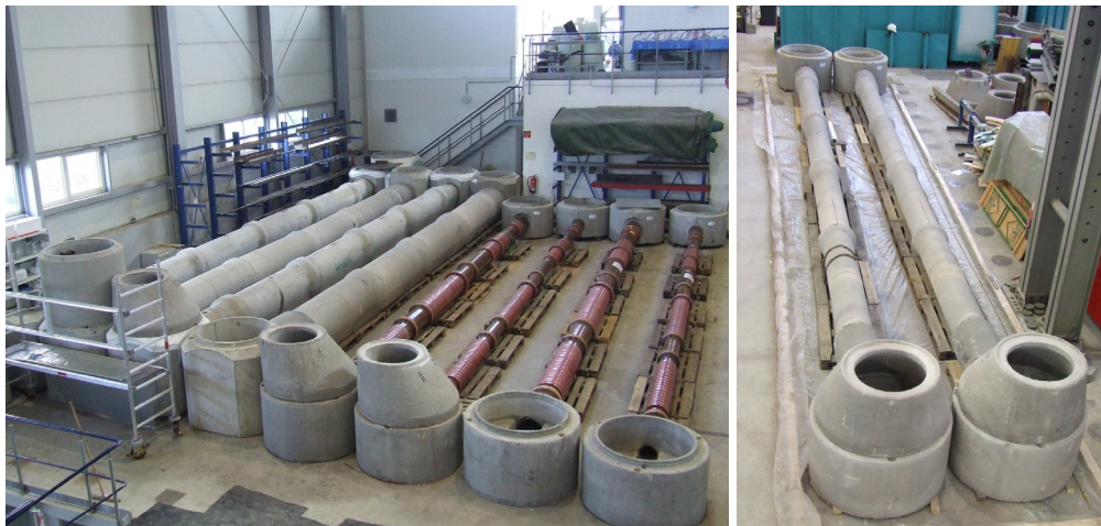
Abb. 2: Teststreckenaufbau für die Innenmanschetten und Kurzliner
