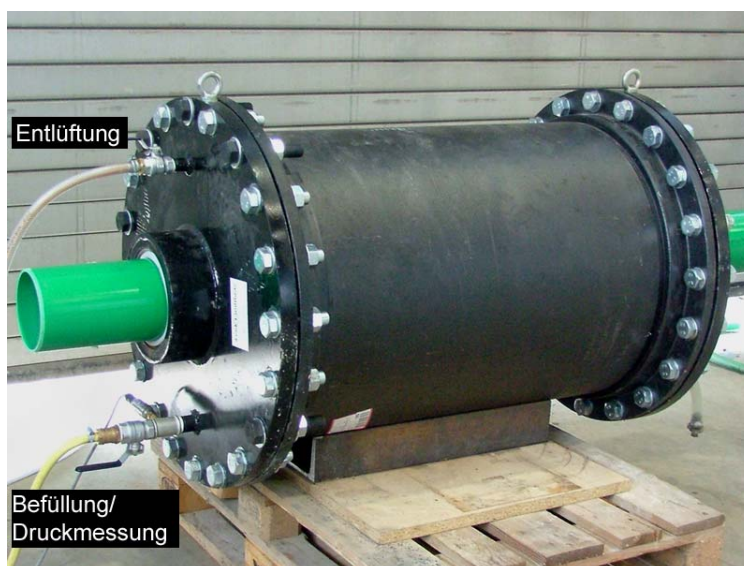
Abb. 4 Vorrichtung zur Wasseraußendruckuntersuchung, bestehend aus einem Gusseisenrohr DN 600 mit Deckeln, die mit Einrichtungen zum Befüllen, Entlüften und zur Druckmessung versehen sind.
