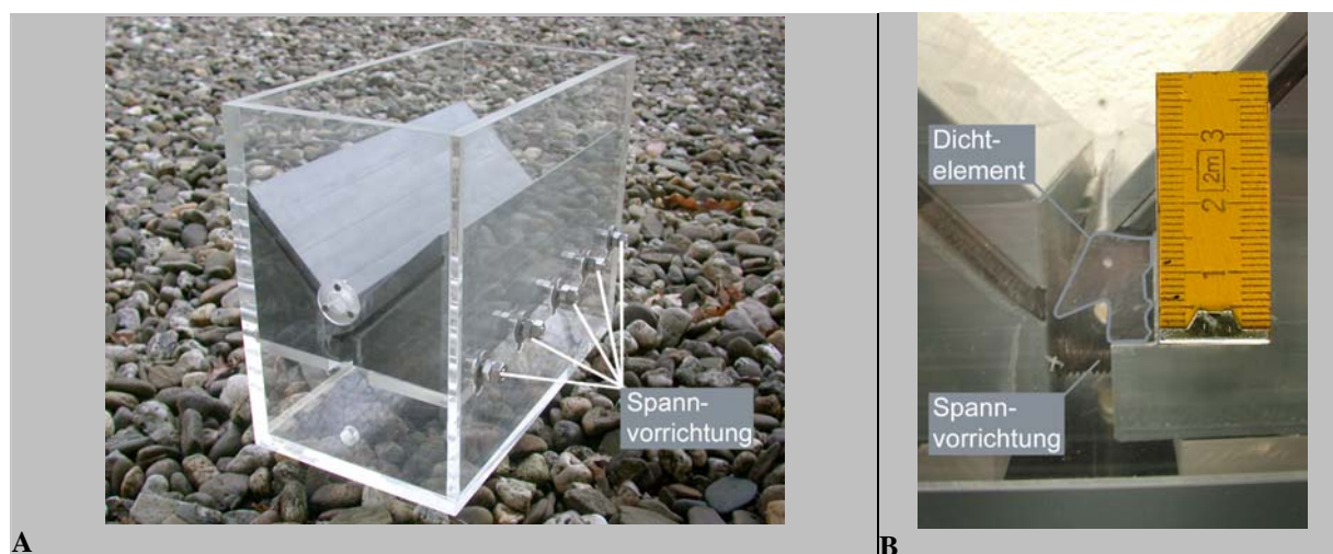
Abb. 9: Untersuchung des Wurzelwachstums an elastomeren Dichtelementen. A Seitenansicht der Vorrichtung. B Detail eines eingebauten Dichtelementes. Der Querschnitt des Dichtelementes wurde für die Abbildung hervorgehoben.
