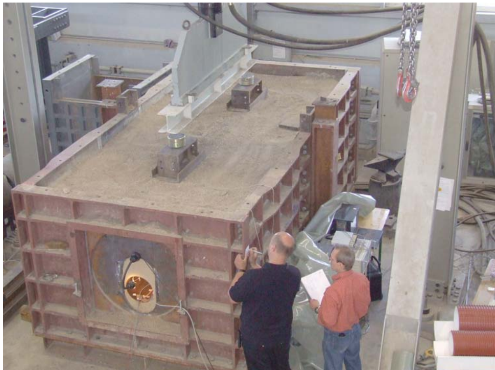
Bild 5 Versuche im Maßstab 1:1 mit Sandbettung
