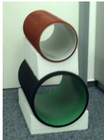
b) Verlegung von 2 Rohren übereinander
