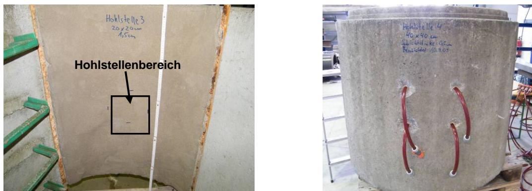
Bild 12 Fertiggestellter Probekörper: Innenseite (links) und Außenseite mit Schlauchanschlüssen zur Wasserdruckbelastung (rechts)
