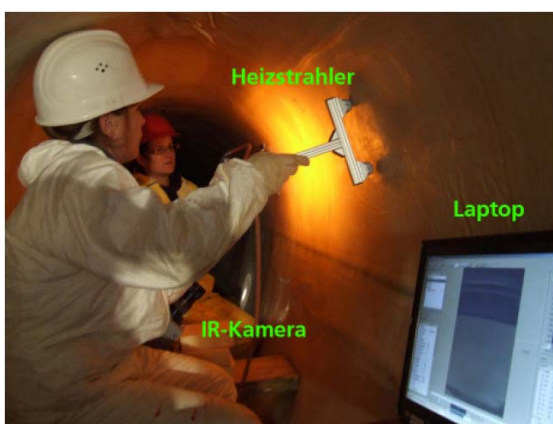
a) Messung im Kanal Abb. 5: Wärmefluss-Thermographie (Fraunhofer WKI, Braunschweig)
