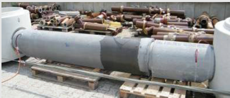
Füllen des Ringraums zur Überprüfung der Ringspaltdurchlässigkeit
