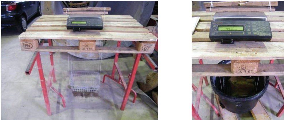
Abb. 36: Konstruktion der Tauchwaage (links); Tauchwaage mit Probekorper (rechts)
