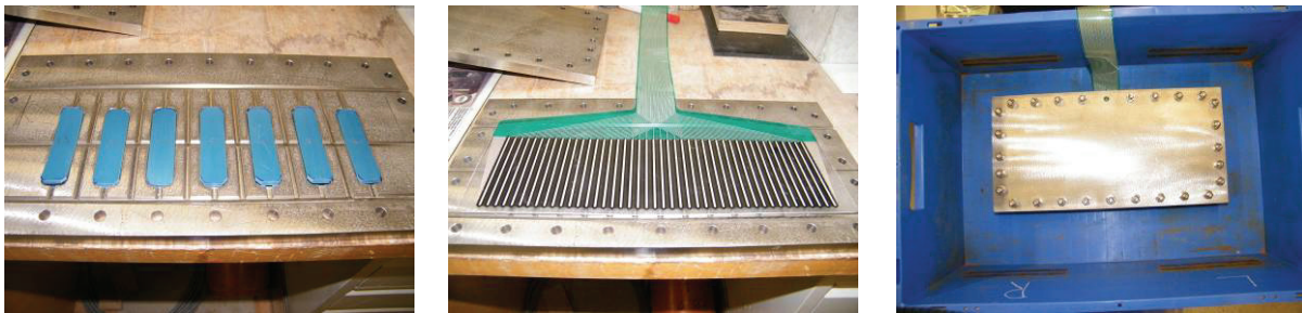
Abb. 52: Konstruktion für die Spannungsmessungen: Stahlplatte mit eingelegten Proben (links); aufgelegte Tekscan-Druckmessfolie ® (Mitte); verschraubte Konstruktion in Behälter eingelegt (rechts)
