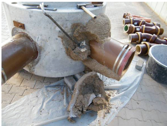
Abb. 35: Anschlussrohr mit teilweise bereits abgetrenntem Injektionsmaterial (links); gesammeltes Injektionsmaterial einer Schachtanschlusssanierung (rechts)
