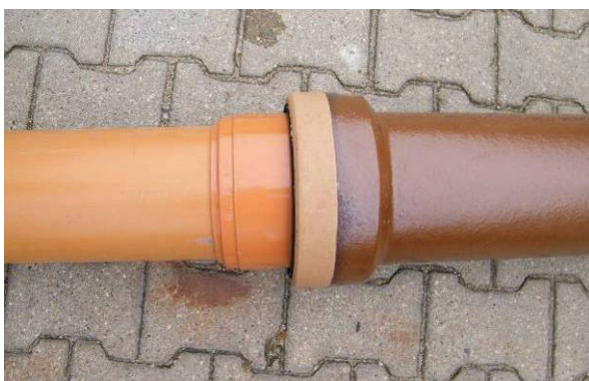
Abb. 54: Werkstoffwechsel von Steinzeugrohr auf PVC-Rohr; Außenansicht (links) und Innenansicht, bei der das Bauteil nicht sichtbar ist (rechts)
