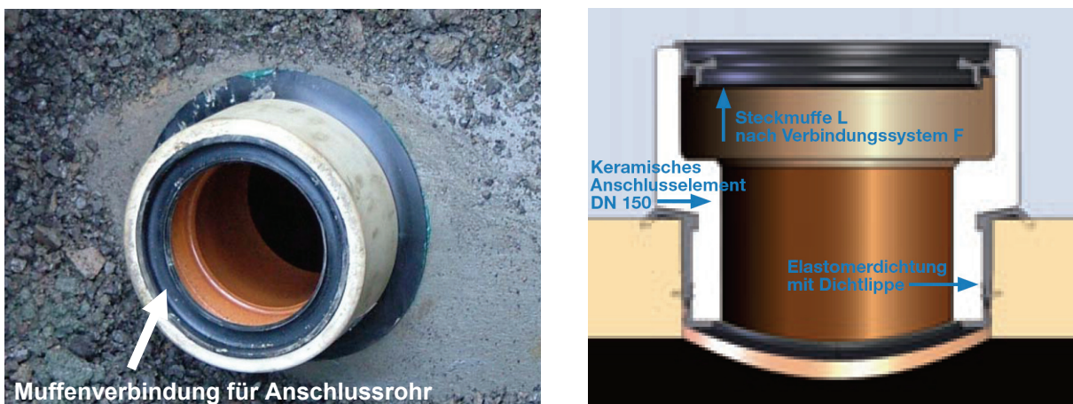
Abb. 8: Außenansicht eines Stutzens mit Abdichtung in der Bohrlochlaibung (links); Schematische Darstellung des Bauteiles in der Bohrlochlaibung (rechts) [27]
