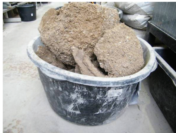
Abb. 35: Anschlussrohr mit teilweise bereits abgetrenntem Injektionsmaterial (links); gesammeltes Injektionsmaterial einer Schachtanschlusssanierung (rechts)
