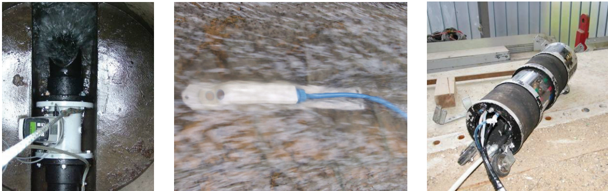
Abb. 56: Magnetisch-Induktive Durchflussmessung (links); Ultraschallmesssensor für die Messung von Wasserstand und Fließgeschwindigkeit (Mitte); Muffendichtheitsprüfgerät mit eingebautem MID-Messgerät z.B. für die Einzelmessung an einem Hausanschluss (rechts)
