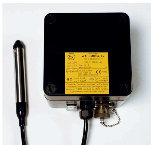
Bild 11: Ex-geschützte mobile Drucksonde (MDS4-Ex „Kanalagent“)
