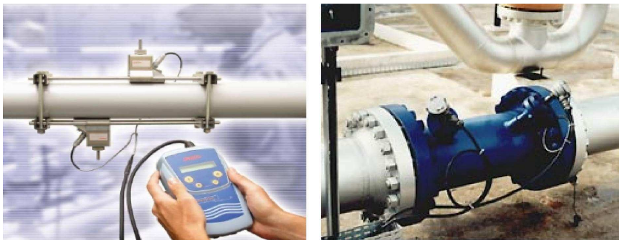
Bild 7: Kalibrierungsmessungen mit dem Messgerät Minisonic der Firma Schmetz
