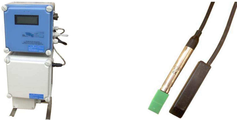
Bild 2: Mobiler Ultraschall-Doppler UGSH und Sensor
