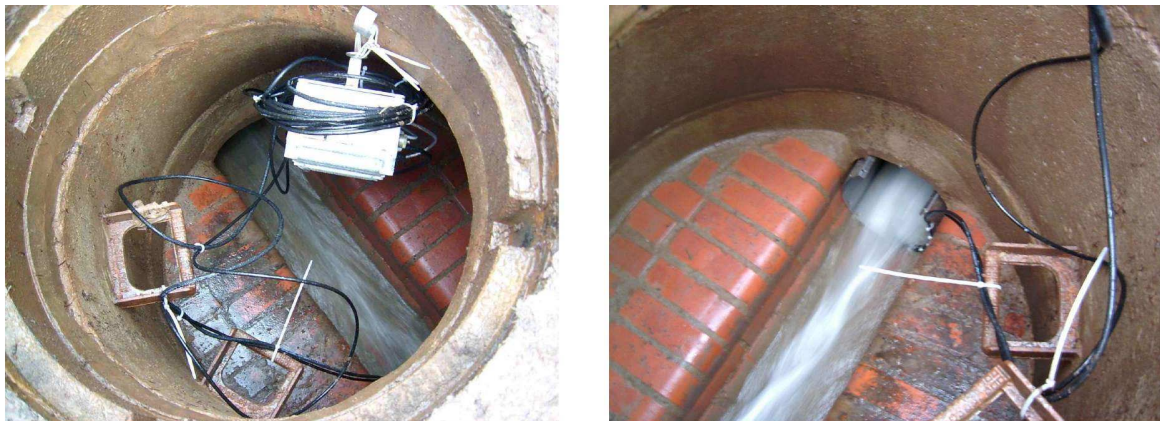
Bild 3: Messschacht mit Kombisonde nach dem Ultraschall-Doppler Prinzip und Datenlogger
