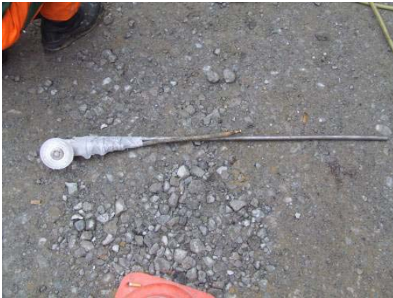
a) Trennschleifer mit Halteverlängerung zur Entnahme von Haltungsproben
