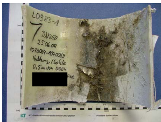
a) Haltungsprobe 1, Sohle
