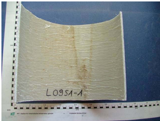
a) Schachtprobe Liner 2 (Schale ca. DIN A4 groß)
