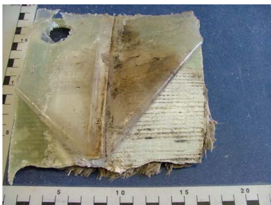
c) Probekörper L1 (frei liegende Fasern), Ansicht Außenseite
