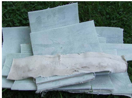
f) Material aus dem Schacht, Probekörper und Jeansschlauch
