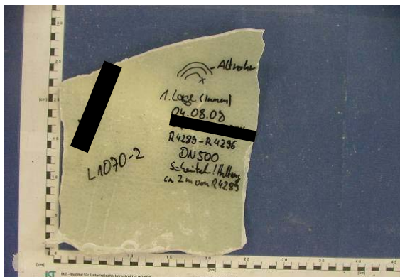
e) Innenseite der Materialprobe (2. Liner), Gewährleistungsabnahme (DN 500)
