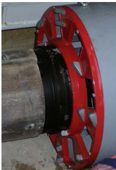
Bild 3-12: Verbindung Stahlverrohrung – Aufweitungsstufe; Versorgungsleitungen und Steuerstand
