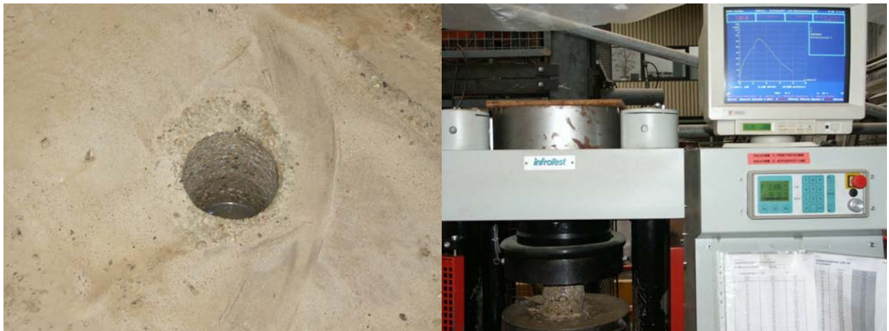
Bild 4-13: Druckfestigkeitsprüfung an Bohrkernen aus dem Betonkörper
