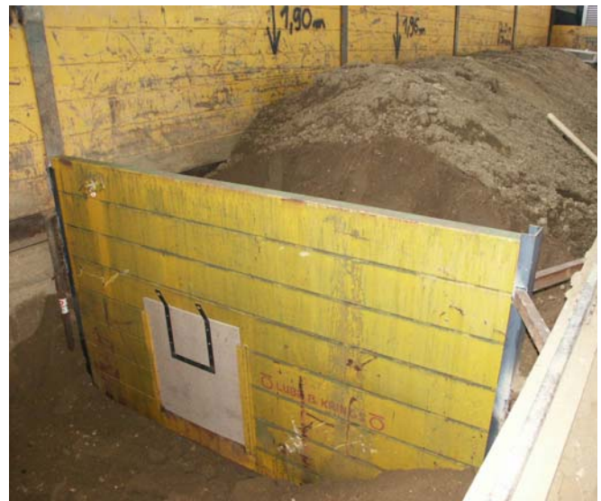
Bild 4-4: Versuchsbahn für Rohrvortriebe am ibb Bild 4-5: Querschott mit Ausfahröffnung
