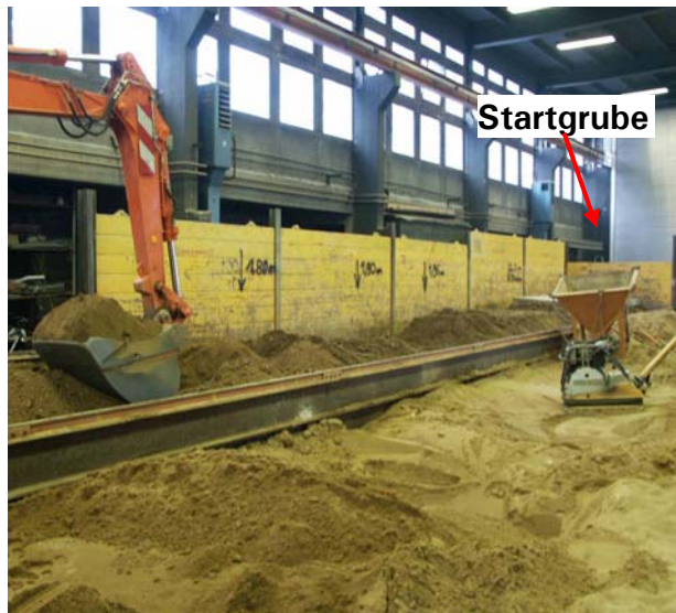
Bild 4-4: Versuchsbahn für Rohrvortriebe am ibb Bild 4-5: Querschott mit Ausfahröffnung
