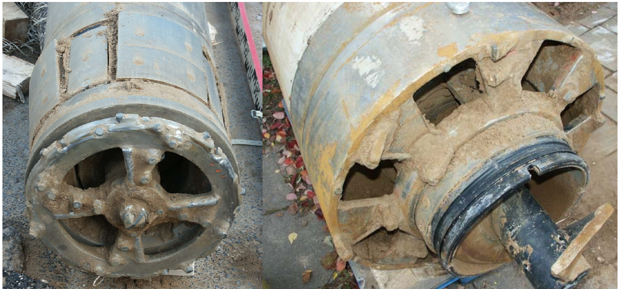
Bild 5-5: Steuerkopf und Aufweitungsstufe nach Abschluss der Vortriebsarbeiten
