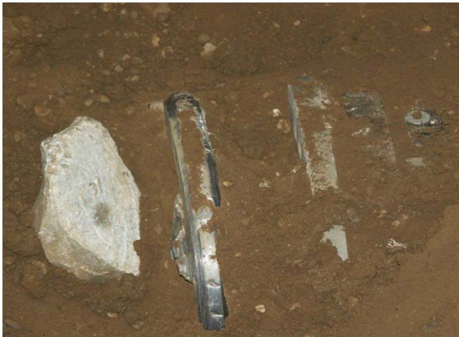
Bild 3-2: freigelegter Bohrkopf mit Stein
