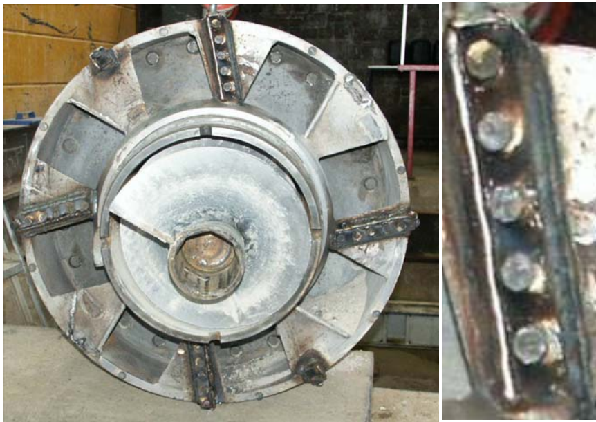
Bild 3-13: Schneidrad mit 8-Kant-Meißeln
