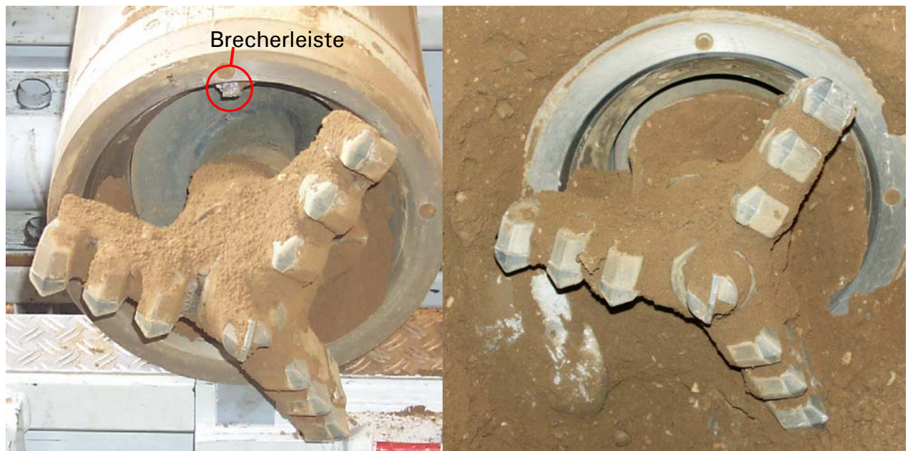
Bild 3-4: Variante des Steuerkopfes mit dreiarmligen Schneidrad
