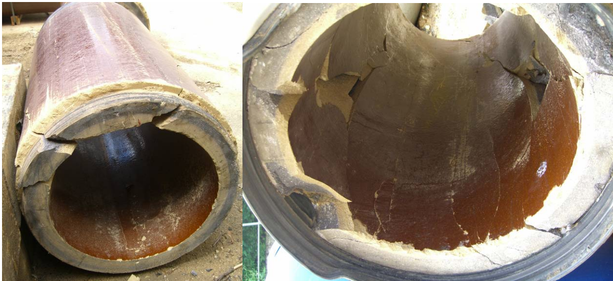
Bild 6.21: Bahnversuch 5: beschädigte Vortriebsrohre
