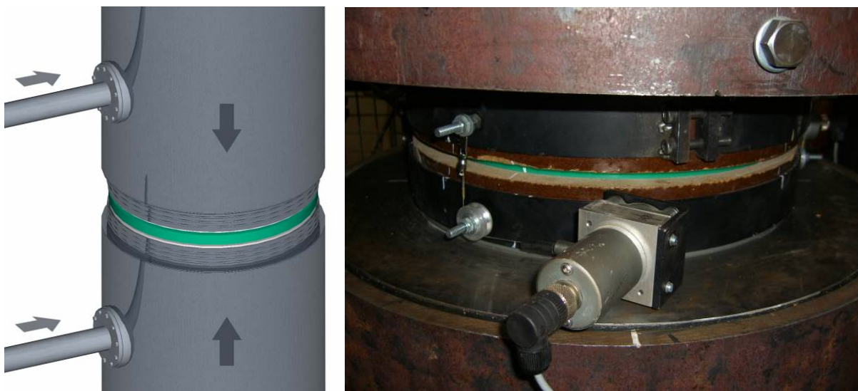
Bild 5.1: modifizierter Versuchsaufbau zur Erprobung von Kunststoffringen im Großversuchsstand
