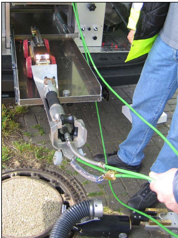
Abb. 65: Lindauer Mini-Schere mit ASYS und Positionierungssystem SPE (unten rechts dargestellt) vor dem Einsatz.
