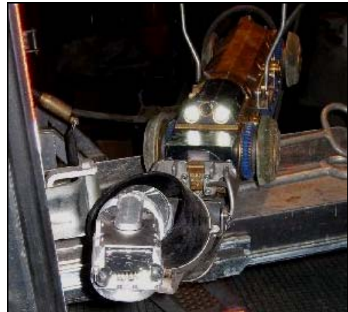
Abb. 19: Lindauer Schere (mini) mit Fahrwagen
