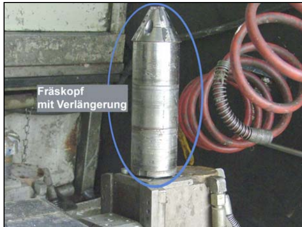
Abb. 43: Zur Entfernung von Wurzelpolstern im Einmündungsbereich der Anschlussleitungen (Abzweige) wurde ein Fräskopf mit einer Verlängerung eingesetzt.
