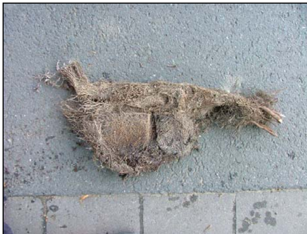
Abb. 45: Aus dem Kanal entferntes Wurzelpolster.
