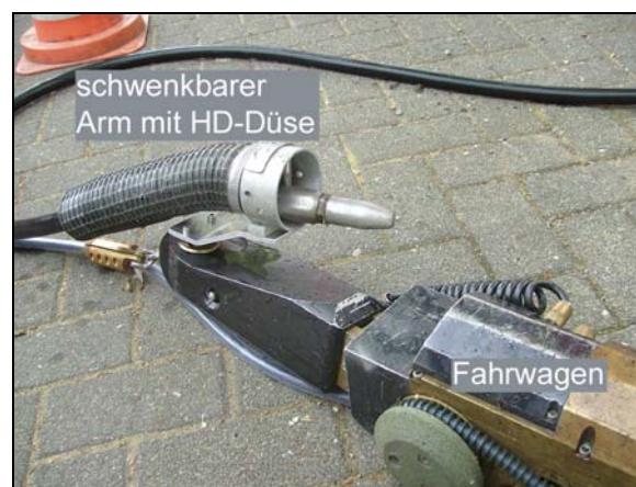
Abb. 67: System SPE der Fa. JT-Elektronik [20]. Der Fahrwagen besitzt neben Kamera und Beleuchtung einen schwenkbaren Arm zur Positionierung eines Reinigungswerkzeugs.
