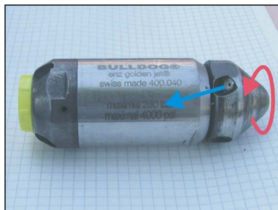
Abb. 70: HD-Rotationsdüse, der Rückstoß des Wasserdruckes aus rückwärts gerichteten Düsen treibt den Düsenkörper nach vorne (am linken Ende der Düse, verdeckt) Zusätzlich befindet sich am rechten Ende ein drehbarer Kopf, der durch die mit dem blauen Pfeil gekennzeichneten, seitlich strahlenden Düse in Rotation versetzt wird.
