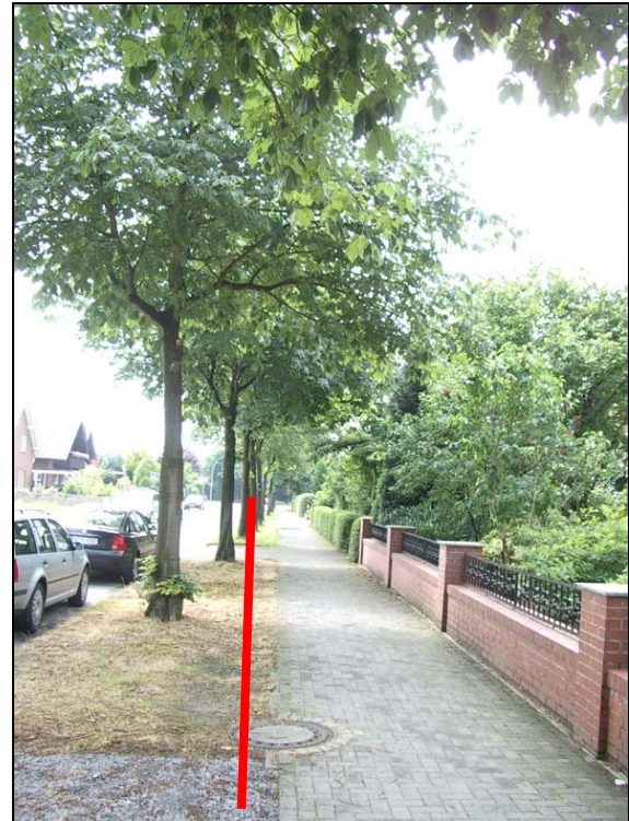
Abb. 24: Lage des Schmutzwassersammlers im Straßenbereich skizziert. A Blick in nördliche Richtung, B Blick in südliche Richtung.
