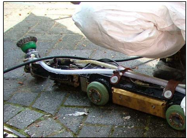
Abb. 50: Pneumatisch betriebener Fräsroboter der Fa. JT-Elektronik: Detail Topfbürste.
