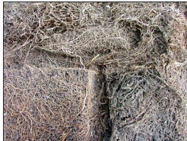
Abb. 46: Detail des aus dem Kanal entfernten Wurzelpolsters.
