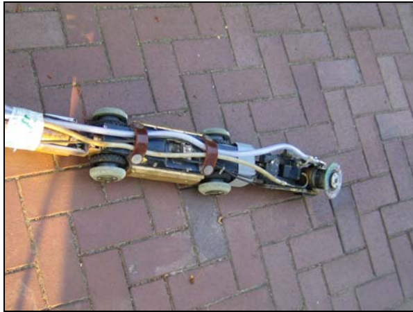
Abb. 47: Pneumatisch betriebener Fräsroboter der Fa. JT-Elektronik mit Trennscheibe als Fräswerkzeug (Gesamtansicht)
