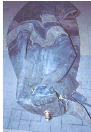
b) Absperrblase (für DN 900)
