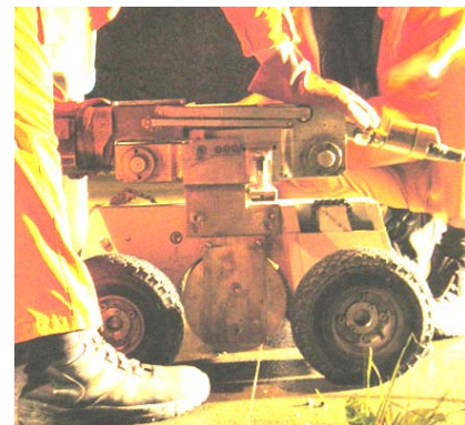
c) Montage der Kamera- und Antriebseinheit
