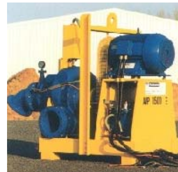
c) AVP 1500 E*, Q_{\max} \approx 458 \text{ l/s} , H_{\max} \approx 25 \text{ m}
