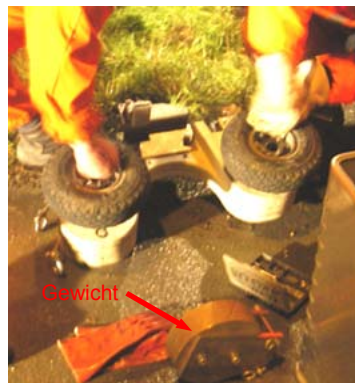
b) Montage der Räder und des Gewichtes
