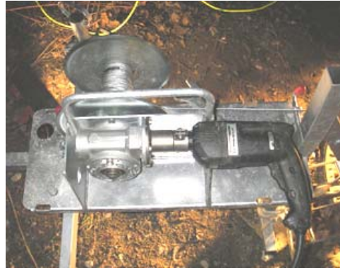
b) elektrisch betriebene Seil-Winde, Antrieb: 1-kW-Bohrmaschine, Foto: IKT
