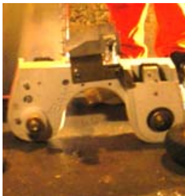
a) Gestell des Großrohr-Fahrwagens
