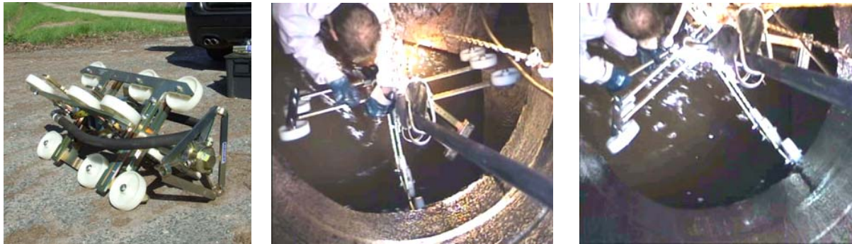
a) Transportzustand b) DN-Anpassung der Gestelles c) Montage der Propellerarme
