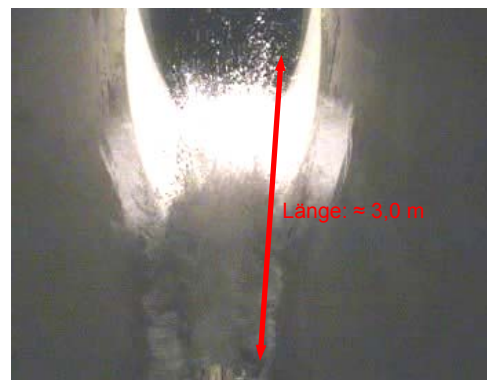
d) Turbulenzen und Spritzwasser hinter der Düse, Länge: ca. 3,0 m
