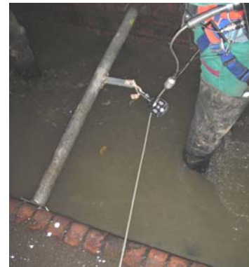
c) Umlenkrolle für Datenkabel über Trockenwettergerinne
