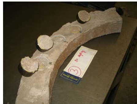
Abb. 83: Haftzugprüfungen an ausgebauten Kreissegmenten
