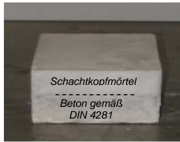
Abb. 93: Verbundprobekörper (Seitenansicht) nach Herstellung
