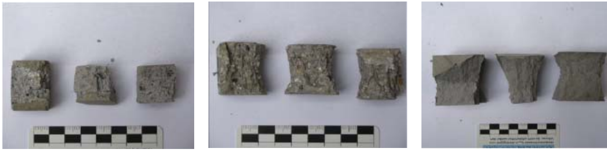
Abb. 71.1/71.2/71.3: Würfelserien der Schächte 4, 10 und 20 nach der Druckfestigkeitsprüfung
