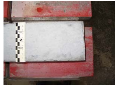
Abb. 94: Verbundprobekörper (Draufsicht) nach Herstellung
