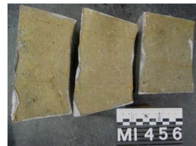
Abb. 74: Serie Schacht 5 nach 28 FTW in 1%iger NaCl-Lösung
