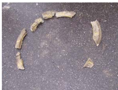
Abb. 68: Markierte Bruchstücke einer Mörtelfuge
