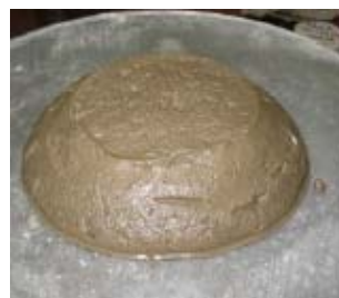
Abb. 113: Ermittlung des Ausbreitmaßes bei einem plastischem Mörtel (Mörtel A)
