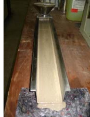
Abb. 115: Ermittlung des Fließmaßes mittels Fließrinne (Mörtel B)
