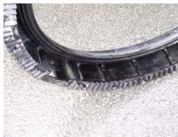
Abb. 30: Ausschnitt eines vertikal aufgerichteten Guss-Rahmens einer VIATOP-Schachtabdeckung mit Verzahnung an der Unterseite
