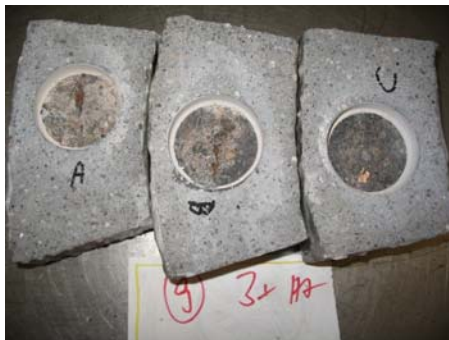
Abb. 82: Haftzugprüfungen an bewitterten Probekörpern
