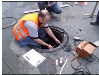
Abb. 51: Ultraschalluntersuchung mittels Ringmessung
