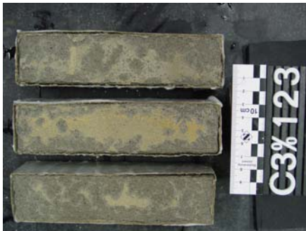
Abb. 90: Serie Mörtel C nach 28 FTW in 3%iger NaCl-Lösung
