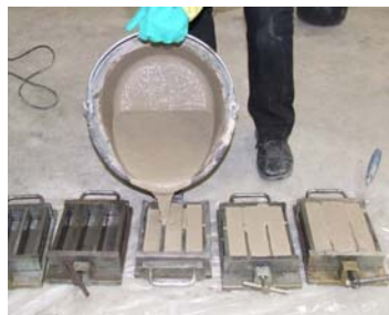
Abb. 118: Herstellung von Mörtelprismen
