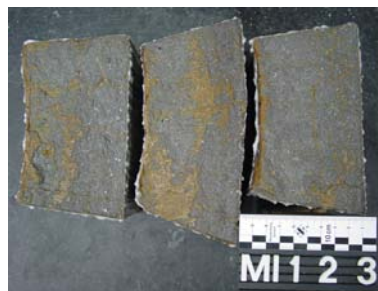
Abb. 73: Serie Schacht 5 nach 28 FTW in 3%iger NaCl-Lösung
