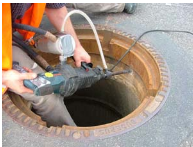
Abb. 57: Entnahme von Bohrmehl
