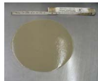
Abb. 114: Ermittlung des Ausbreitmaßes bei einem Vergussmörtel (Mörtel C)
