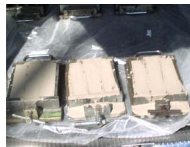
Abb. 125: Mit Mörtel verfüllte Stahlformen
