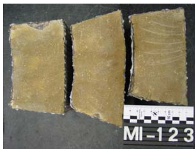
Abb. 72: Serie Schacht 5 vor Frost-Tau-Wechsel (FTW)
