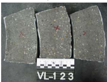
Abb. 76: Serie Schacht 9 nach 28 FTW in 3%iger NaCl-Lösung
