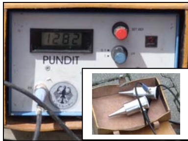
Abb. 53: Ultraschallmessgerät mit Sender und Empfänger
