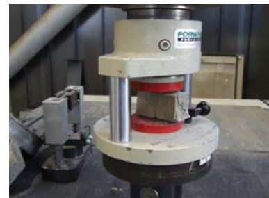
Abb. 119: Druckfestigkeitsprüfung gemäß DIN EN 196, Teil 1 [51]
