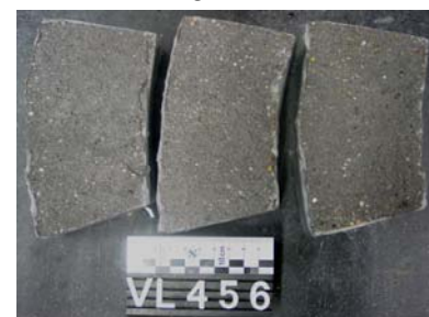
Abb. 77: Serie Schacht 9 nach 28 FTW in 1%iger NaCl-Lösung
