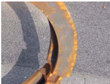
Abb. 29: Ausschnitt eines vertikal aufgerichteten Guss-Rahmens mit glatter Unterseite
