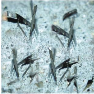
Abb. 2: Stahlfasern des „ERGELIT-superfix 35F“ unter dem Mikroskop [9]
