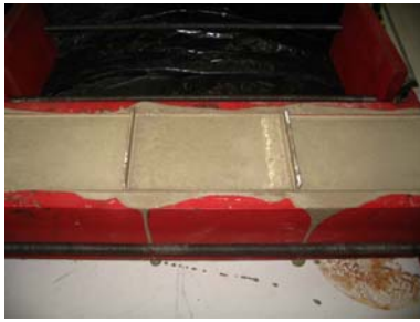
Abb. 92: Herstellung der Probekörper mittels Rahmenkonstruktion
