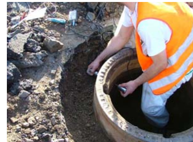
Abb. 55: Durchschallung der Mörtelfuge von außen nach innen
