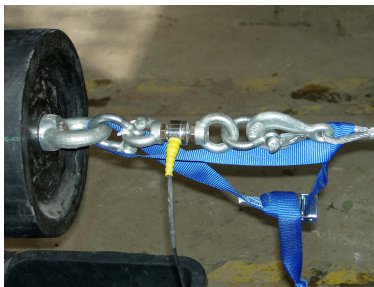
Abbildung 7.13: Kraftmessdose zur Erfassung der Zugkraft
