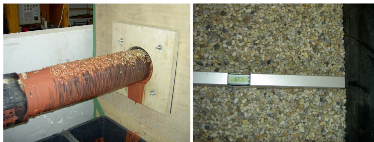
Abbildung 7.41: Großversuch 2: Bodenauszug aus dem Versuchsstand (links); Setzungen an der Oberfläche (rechts)
