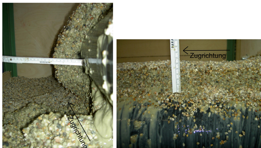
Abbildung 7.32: Großversuch 1: Messung des standfesten Bodens
