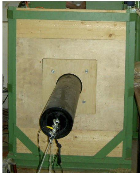
Abbildung 7.2: Eingebautes Vortriebsrohr mit Lippendichtung an der Zugseite
