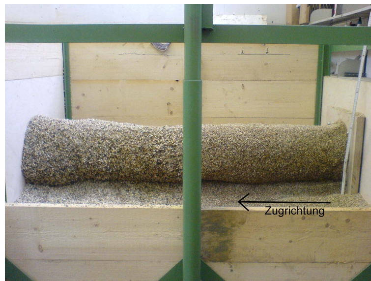
Abbildung 7.30: Großversuch 1: Freigelegter Rohrstrang, standfester Boden um das Vortriebsrohr
