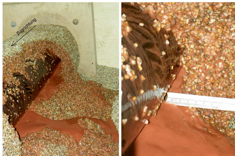
Abbildung 7.45: Großversuch 2: Vollständig mit polymermodifizierter Bentonitsuspension gefüllter Ringspalt
