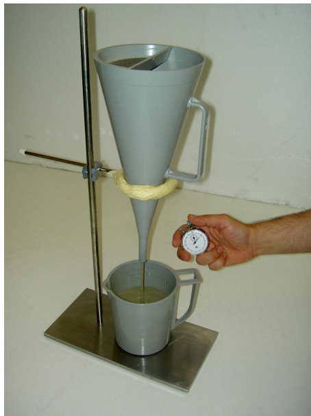
Abbildung 4.6: Bestimmung der Marsh-Zeiten mit dem Marsh-Trichter
