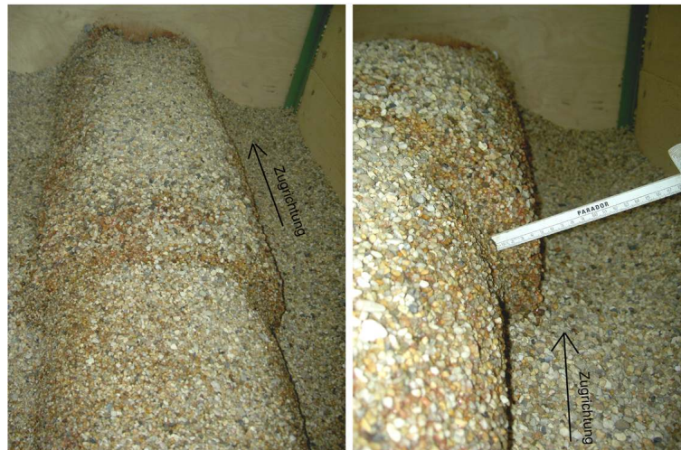
Abbildung 7.42: Großversuch 2: Übergang vom feinkörnigen zum grobkörnigen Lockergestein erkennbar an größere Eindringtiefe der Suspension
