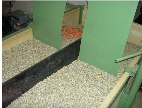
Abbildung 7.6: Einbau des nichtbindigen Lockergesteins mit geologischem Wechsel
