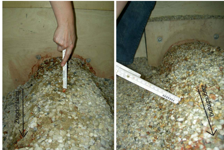
Abbildung 7.54: Großversuch 3: Messung des standfesten Bodens (links: Sand D; rechts: Sand C)
