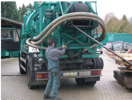
Abbildung 5-24: Spülfahrzeug (links) und Spüldüse im Steinzeugrohr (rechts)
