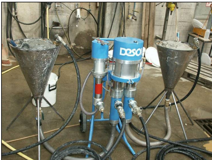
Abbildung 3-4: Injektionspumpe und Materialtrichter
