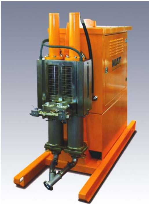
Abbildung 4-15: Doppelpungerpumpe mit Funktionsprinzip
