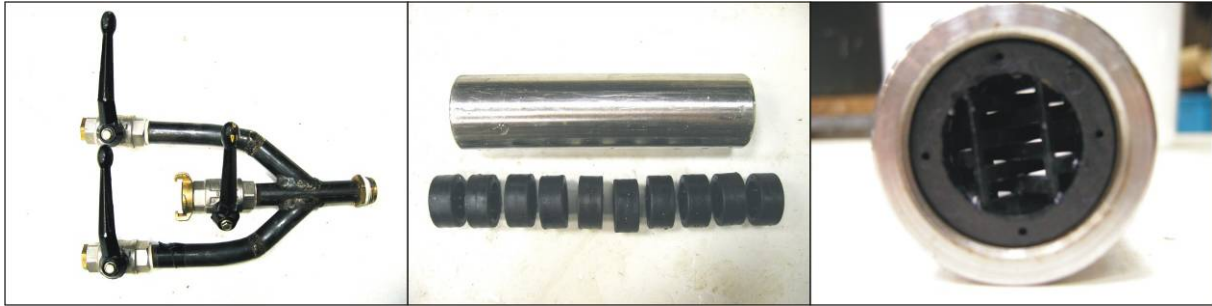
Abbildung 3-3: Statischer Mischer mit Anschlussstück für Material- und Wasserzuleitungen
