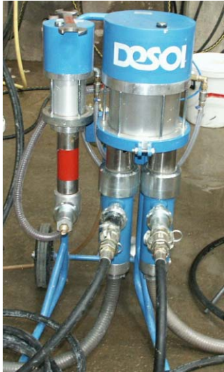
Abbildung 4-14: Pneumatisch betriebene Doppelkolbenpumpe
