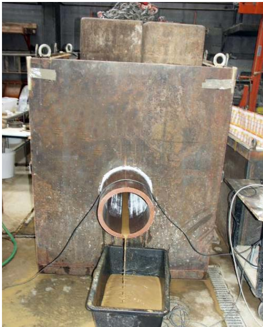
Abbildung 5-4: Vorerprobung mit Grundwassersimulation
