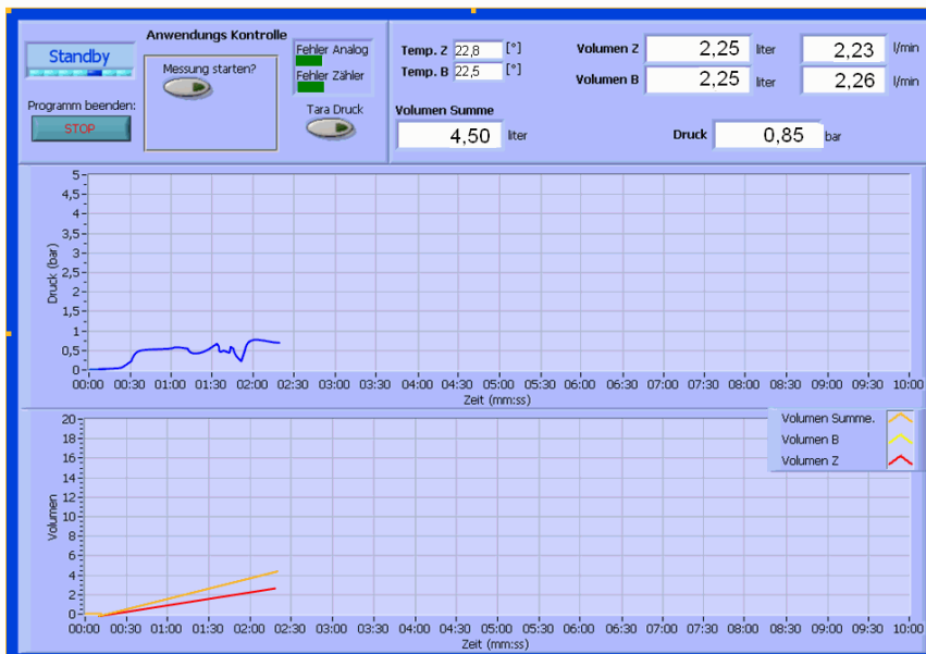
Abbildung 4-16: Anzeige der Verpressrate und des Injektionsdrucks
