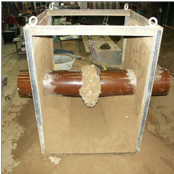
Abbildung 5-1: Versuchskasten mit freigelegtem Injektionskörper (links), Abmessungen (rechts)
