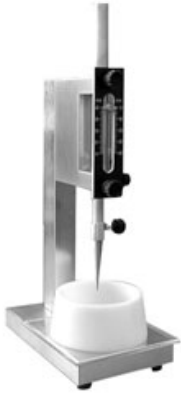
Abbildung 4-10: Vicatgerät mit Tauchkonus
