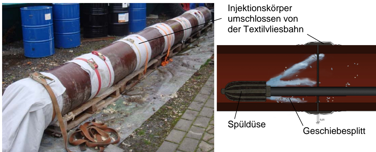
Abbildung 5-23: Testhaltung für Hochdruckspülversuch
