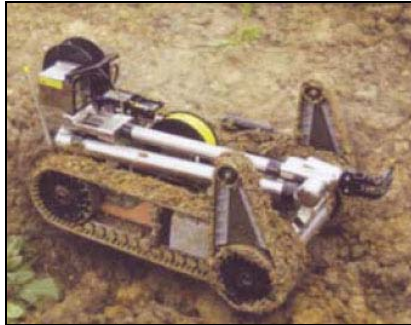
Abbildung 160: Intelligenter Fernlenk-Miniaturmanipulator PackBot EOD [82]
