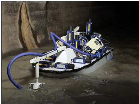
Abbildung 95: Prototyp des Schadenerkennungssystems (SEK) [113]
