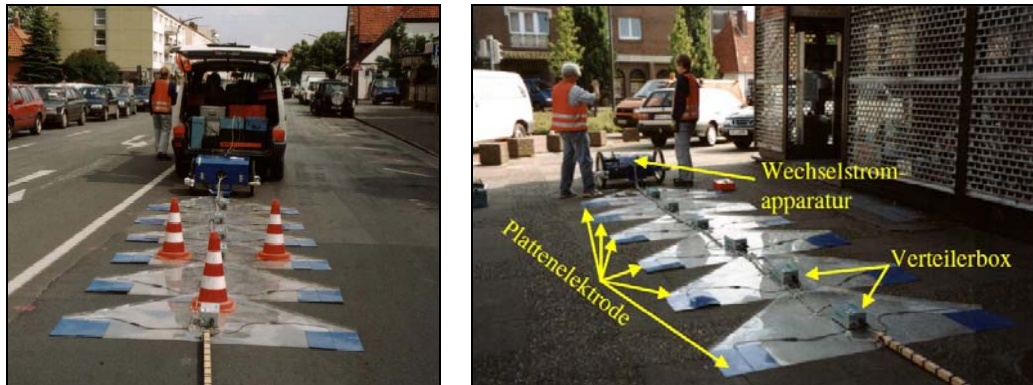
Abbildung 138: Messanordnung zur Anwendung der kapazitiven Geoelektrik und Aufbau der Multi-Kanal-Messanordnung [143]
