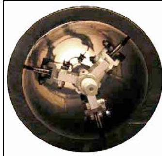
Abbildung 78: PipeTrack - System zur Inspektion von Öl- und Gasleitungen [95]
