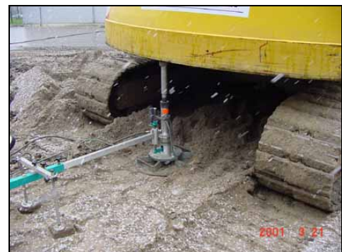
Abbildung 49: Verdichtungskontrolle durch einen Lastplattendruckversuch [22]
