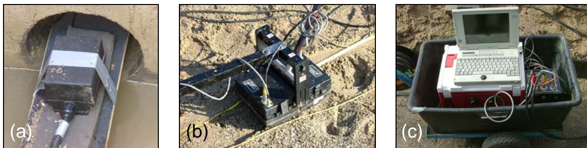
Abbildung 140: Messung mit einer 1.200 MHz Antenne im Kanalrohr (a), einer 900 MHz Antenne an der Geländeoberfläche (b) und das Messwertaufnahmesystem (c) [22]
