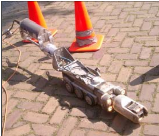
Abbildung 108: Kanalkamerafahrwagen mit Kanalradarantenne auf einem 360°-drehbaren Trägersystem [122]
