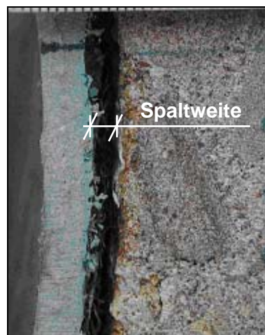
Abbildung 39: Rohr mit einem 10 Jahre alten Schlauchliner, Detaildarstellung des Kontaktbereiches zwischen Schlauchliner und Altrrohr mit Ringspalt [41]
