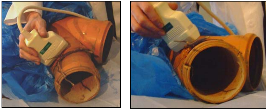
Abbildung 72: Untersuchung einer Rohrverbindung mit Wurzeleinwuchs mittels Ultraschall (7,5 MHz) [22]
