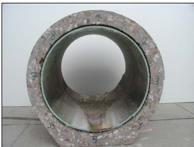
Abbildung 39: Rohr mit einem 10 Jahre alten Schlauchliner, Detaildarstellung des Kontaktbereiches zwischen Schlauchliner und Altrrohr mit Ringspalt [41]
