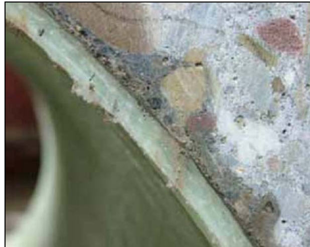
Abbildung 38: Ausbau eines Rohres mit einem 10 Jahre alten Schlauchliner, Detaildarstellung des Kontaktbereiches zwischen Schlauchliner und Altrrohr ohne Ringspalt [41]
