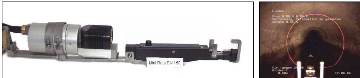
Abbildung 62: Externe Deformationsmessvorrichtung und an die Rohrwandung projektierter Laserkreis [55]
