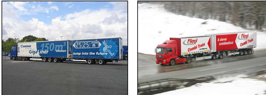
Abbildung 19: Nutzfahrzeuge mit einem zulässigen Gesamtgewicht von 60 t (Krone Giga Liner [26], Fiegl Combi Train [27])
