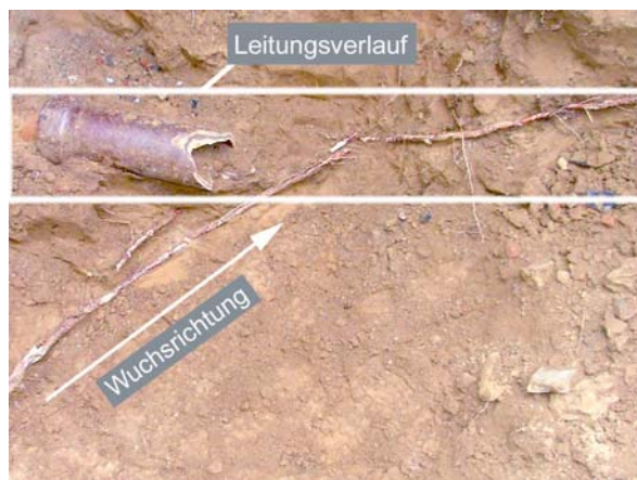
Abb. 35: Untersuchungsstelle C, Leitungsgraben. A Eine Wurzel ( \varnothing 20 mm) trifft diagonal auf den Leitungsgraben, ändert ihre Wuchsrichtung und folgt dem Leitungsverlauf. (Die Wurzel wurde bei der Aufgrabung durchtrennt, die Lage ist unverändert.) B Im Zwickelbereich der Leitung hat sich ein kräftiges Wurzelgeflecht ausgebildet.
