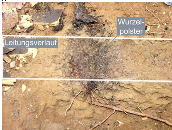
Abb. 33: Ausbreitung der Wurzeln im Bereich der Untersuchungsstelle B. A Eine Wurzel wächst in 0,1 m Abstand parallel zur Leitung und verzweigt sich unter der Rohrverbindung. B Geöffnete Rohrverbindung: Im Ringspalt hat sich ein Wurzelpolster gebildet. C Nach Ausbau der Leitung: Die seitlich neben dem Rohr liegende Wurzel verzweigt sich unterhalb der Rohrverbindung zu einem Wurzelpolster.
