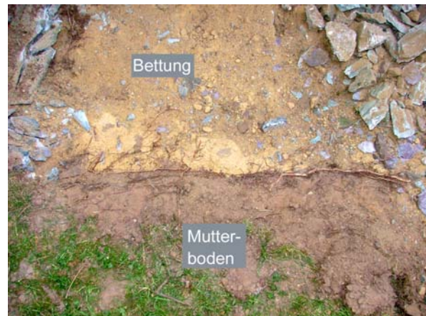
Abb. 34: Untersuchungsstelle C. A Bodenprofil: Der locker verfüllte Leitungsgraben ist von einer Betonplatte und einem in Sand gebettetem Gehweg aus Natursteinplatten bedeckt. B An der Grenze zwischen Bettung und Mutterboden wachsen zahlreiche Wurzeln.
