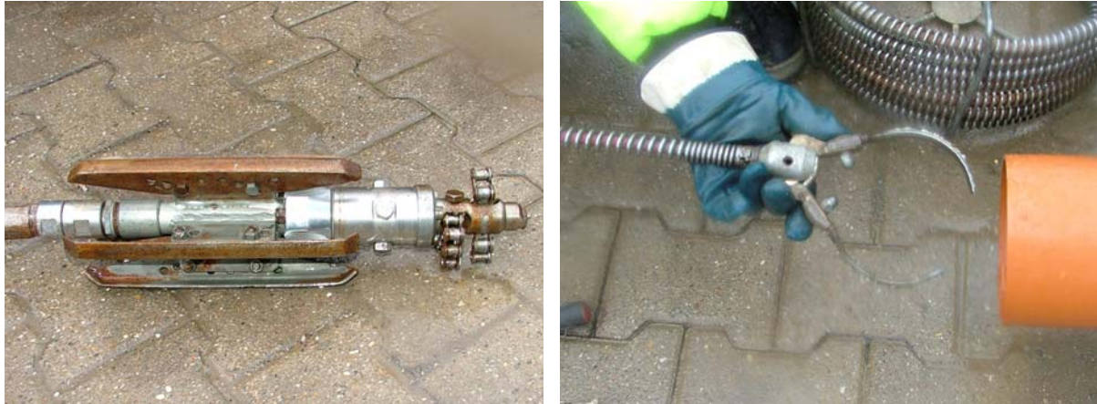
Abb. 63: Werkzeuge zur mechanischen Wurzelentfernung. A Kettenschleuderfräse mit hydraulischem Antrieb. B Wurzelfräse mit mechanischem Antrieb.
