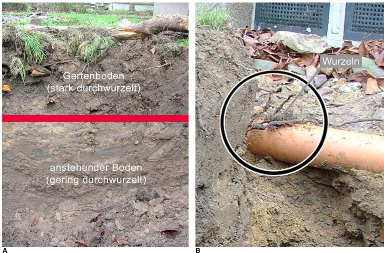
Abb. 20: Untersuchungsstelle A. A Bodenprofil. B Es ist deutlich zu erkennen, dass Wurzeln vermehrt im Bettungs- bzw. Verfüllmaterial der Leitung gewachsen sind. Der umgebende Boden ist nahezu frei von Wurzeln.
