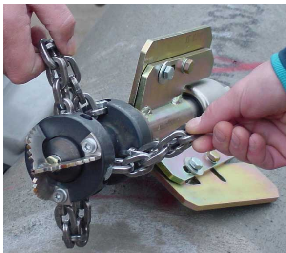
Abb. 52: Kettenschleuder zur Beseitigung von Wurzelschäden.
