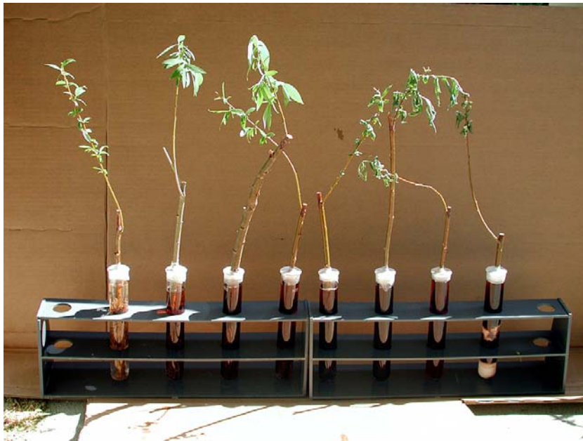
Abb. 47: Versuchsaufbau zur Ermittlung des Erfolges von Verfahren zur chemischen Wurzelentfernung.
