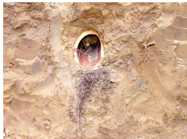
Abb. 35: Untersuchungsstelle C, Leitungsgraben. A Eine Wurzel ( \varnothing 20 mm) trifft diagonal auf den Leitungsgraben, ändert ihre Wuchsrichtung und folgt dem Leitungsverlauf. (Die Wurzel wurde bei der Aufgrabung durchtrennt, die Lage ist unverändert.) B Im Zwickelbereich der Leitung hat sich ein kräftiges Wurzelgeflecht ausgebildet.
