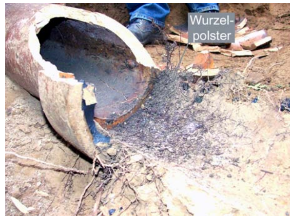
Abb. 33: Ausbreitung der Wurzeln im Bereich der Untersuchungsstelle B. A Eine Wurzel wächst in 0,1 m Abstand parallel zur Leitung und verzweigt sich unter der Rohrverbindung. B Geöffnete Rohrverbindung: Im Ringspalt hat sich ein Wurzelpolster gebildet. C Nach Ausbau der Leitung: Die seitlich neben dem Rohr liegende Wurzel verzweigt sich unterhalb der Rohrverbindung zu einem Wurzelpolster.
