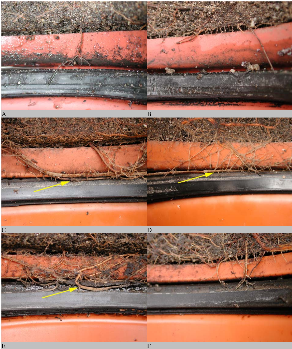
Abb. 95: Auswertung der Outside-In-Versuche A Rehau PVC KG SN 4, Variation 1. B Rehau PVC KG SN 4, plan - Variation 2. C Ostendorf PVC KG - Variation 1. Seitenwurzeln sind in Richtung des Dichtelementes gewachsen (Pfeil). D Ostendorf PVC KG - Variation 2. Seitenwurzeln sind in Richtung des Dichtelementes gewachsen (Pfeil). E Wavin PVC KG - Variation 1. Seitenwurzeln sind in Richtung des Dichtelementes gewachsen (Pfeil). F Wavin PVC KG - Variation 2.
