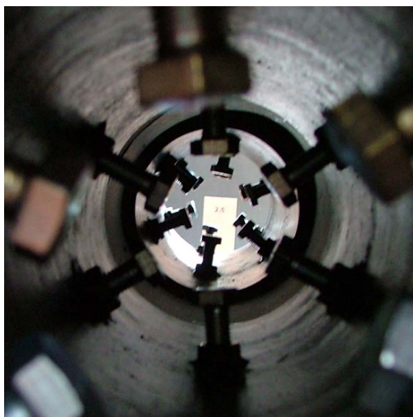
Abb.58: Rohrverbindung Awadukt SN4 PVC, bei einem Außenüberdruck von 3,0 bar. Kein Wassereintritt.
