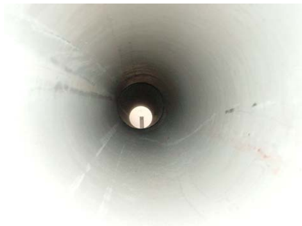
Abb.86: Rohrverbindung der Saint Gobain Gussrohr GmbH, Typ Integral Muffenrohr bei einem Außenüberdruck von 1,0 bar. Kein Wassereintritt.
