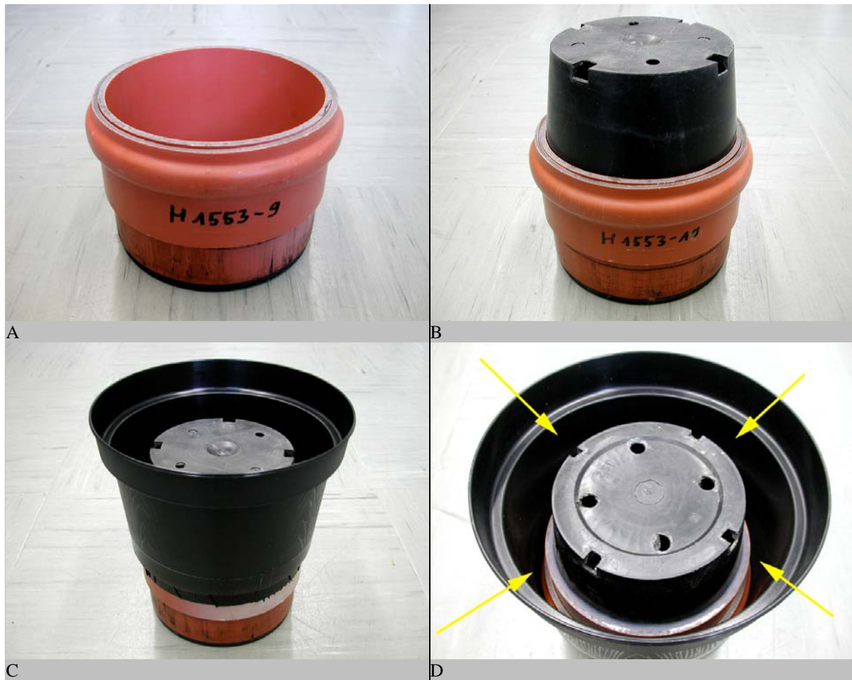
Abb. 93: Kulturgefäße für die Outside-In-Versuche (Variation 1, vgl. Abb. 91a). A Zusammenfügen von Muffe und Spitzende. B Anbringen einer Kunststoffhaube (Blumentopf) zur Verminderung des Volumens. C Kulturgefäß nach Anbringen eines zweiten Gefäßes zur Erzeugung eines minimalen Wurzelraumes. D wie C, Ansicht von oben, hier ist der verbleibende Raum im Kulturgefäße deutlich erkennbar (Pfeile).
