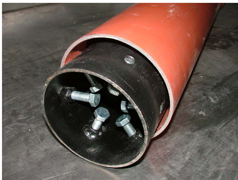
Abb. 37: Stützvorrichtung zur Vermeidung von Formveränderungen (Beulen) während der Untersuchung von Kunststoffrohren (nicht eingebaut, nicht verspannt).
