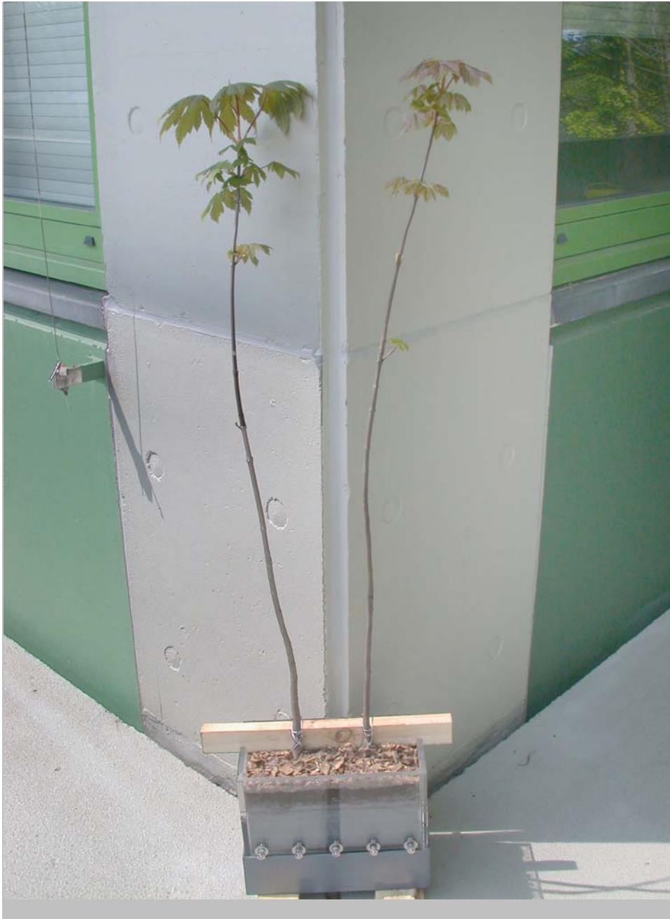
Abb. 99: Vorrichtung zur Untersuchung des Wurzelwachstums an elastomeren Dichtelementen. Kultur der Versuchspflanzen Acer pseudoplatanus .
