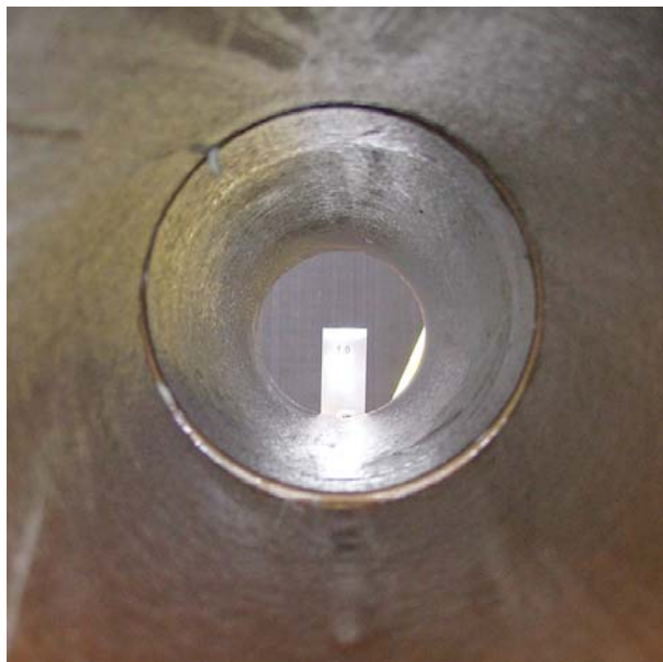
Abb.41: Rohrverbindung Steinzeug Cerafix DN 150, bei einem Außenüberdruck von 1,0 bar. Kein Wassereintritt.
