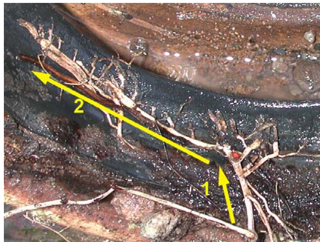
Abb. 2: Änderung der Wuchsrichtung einer Wurzel aufgrund eines Hindernisses. Die Wurzel wächst in Richtung der Elastomerdichtung (1), ändert bei Kontakt mit der Dichtung die Wuchsrichtung und wächst dann entlang der Dichtung (2).
