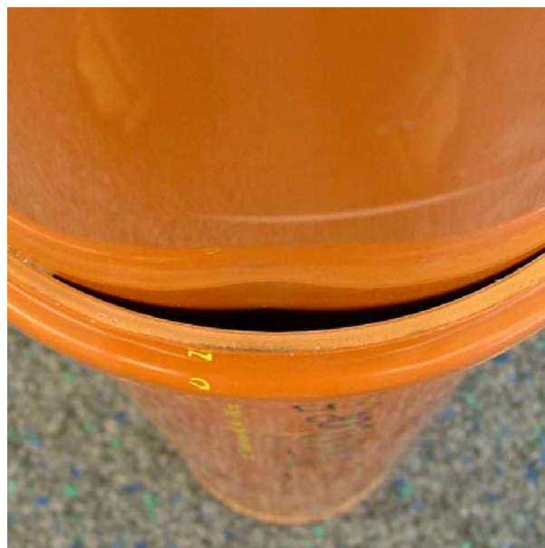
Abb.54: Rohrverbindung Ostendorf PVC-KG. Angestrebte Druckstufe 4 bar. Hier Wassereintritt bei einem Außenüberdruck von ca. 3,7 bar. Verformung des Spitzendes.
