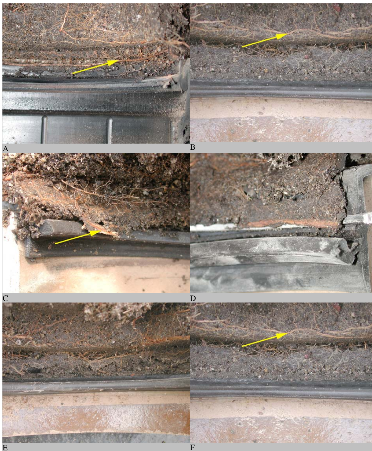
Abb. 97: Auswertung der Outside-In-Versuche Keramikrohre A Euroceramic Eurotop - Variation 1. Wurzeln befinden sich im Zwickel zwischen dem Dichtelement und dem Spitzende (Pfeil). B Euroceramic Eurotop - Variation 2. Wurzeln befinden sich unterhalb des Dichtelementes (Pfeil). C Euroceramic Eurotrade - Variation 1. Wurzeln befinden sich im Zwickel zwischen dem Dichtelement und dem Spitzende (Pfeil). D Euroceramic Eurotrade - Variation 2. E Steinzeug Cerafix L - Variation 1. F Steinzeug Cerafix L - Variation 2. Wurzeln befinden sich im äußeren Ringraum der Rohrverbindung (Pfeil).
