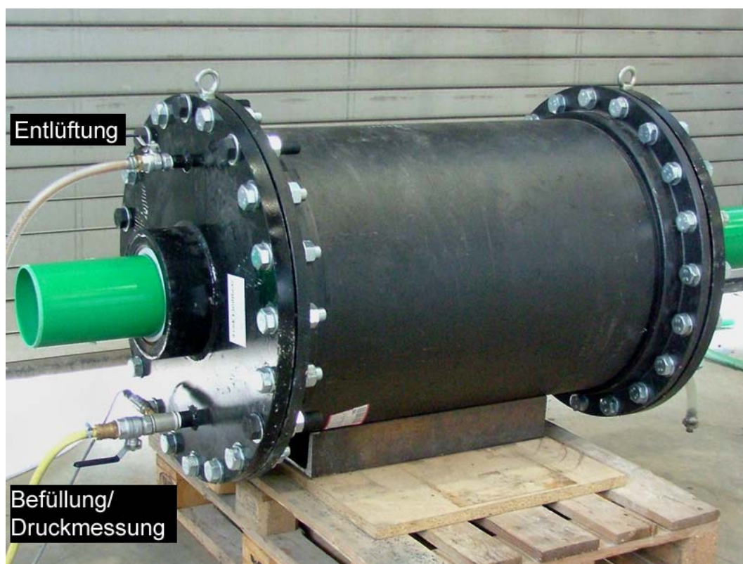
Abb. 36 Vorrichtung zur Wasseraußendruckuntersuchung, bestehend aus einem Gusseisenrohr DN 600 mit Deckeln, die mit Einrichtungen zum Befüllen, Entlüften und zur Druckmessung versehen sind.
