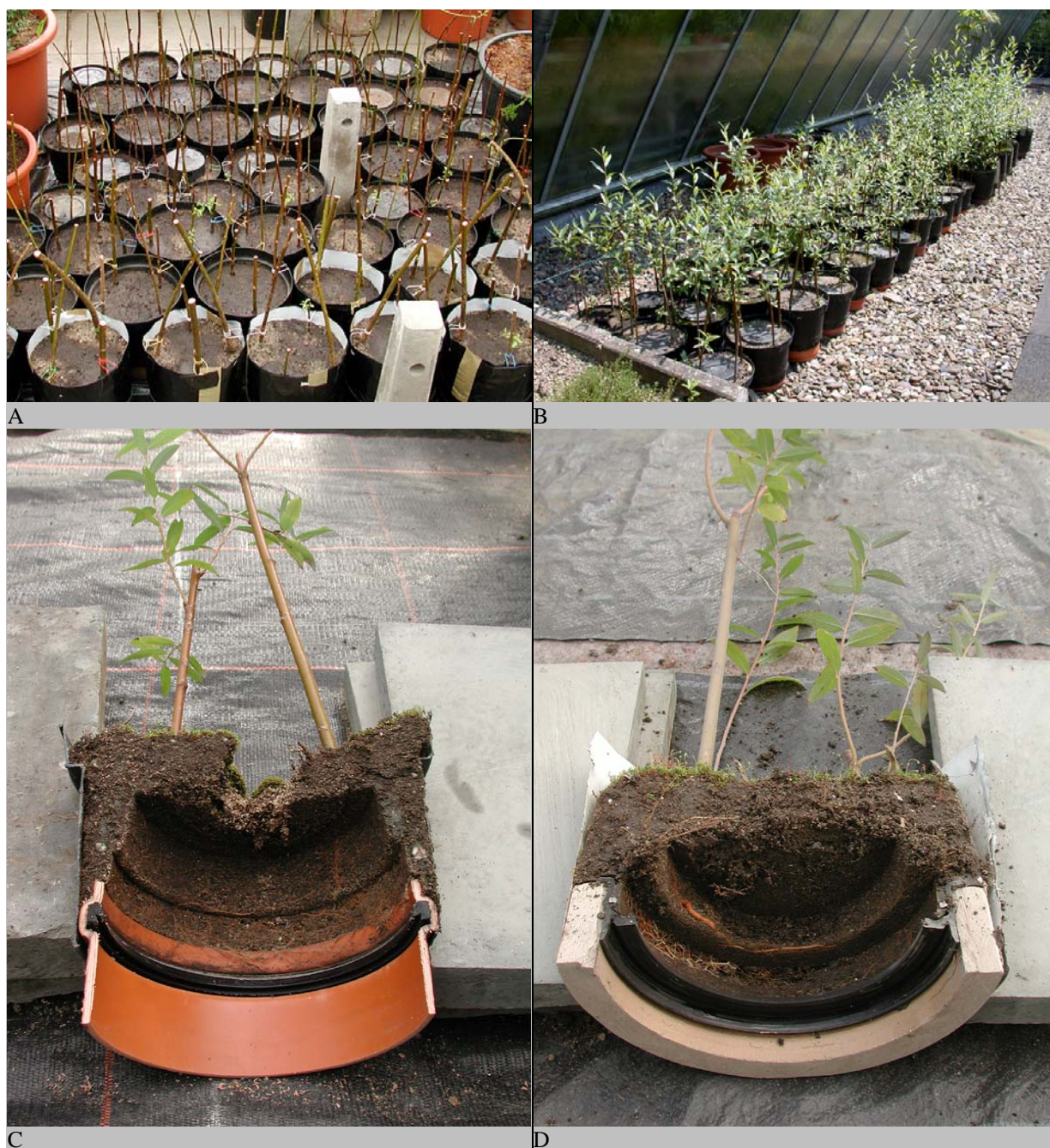
Abb. 94: Durchführung der Outside-In-Versuche. A Bepflanzung der Kulturgefäße. B Kontrolle der Versuchspflanzen nach Ablauf einer Zeit von 6 Monaten. C Öffnung eines Kulturgefäßes aus PVC-U. Die Rohrverbindung wurde längs aufgetrennt, ohne das Eintreten räumlicher Verlagerungen an den Wurzeln. C wie D , Öffnung eines Kulturgefäßes aus Keramik, ohne Beeinträchtigung der vorhandenen Wurzeln.
