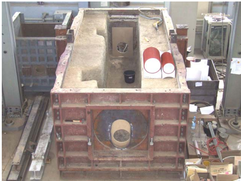
Bild 53: Versuchsstand mit eingebautem Flüssigboden und Rohrgraben
