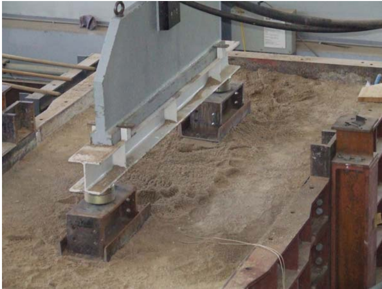
Bild 58 Einleitung der Oberflächenlast bis 400 kN
