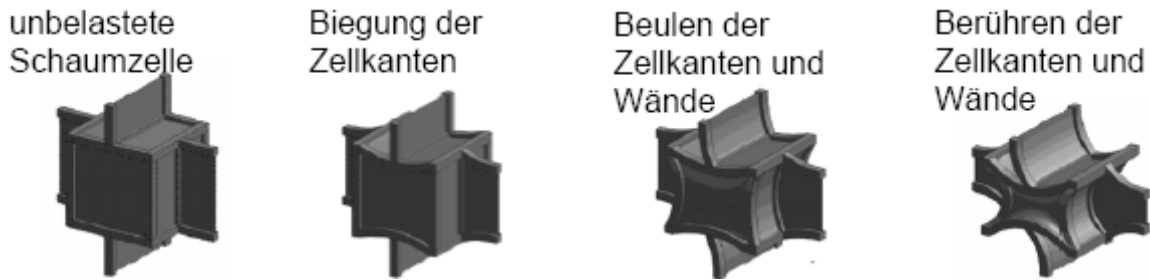
Bild 24 Deformation von Schaumstoffzellen unter zunehmender Druckbelastung - Schematische Darstellung [22]
