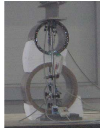
Bild 51 Scheiteldruckversuch Ergebnis Steinzeug DN 200/DN 300 (Doppel) (ddl1 = Änderung dl1, ddl3 = Änderung dl3)
