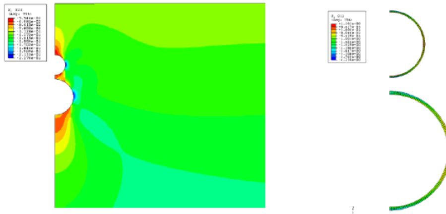
Bild 93 Spannungen in Boden und Rohr, PVC, Einbaufall II, h = 0,5\text{ m}
