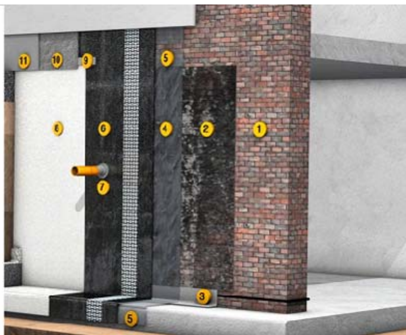
Abbildung 9-4: Lastfall „Nicht drückend“, außenliegende Abdichtung im Bestand, Beispiel System Saint-Gobain – Weber
