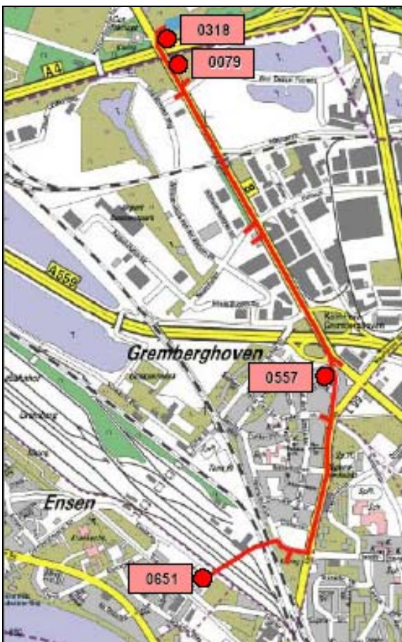
Abb. 12.5: Schächte der Fließzeitmessungen in der Kanal-Teststrecke Köln-Ensen (Quelle Kartenhintergrund: STADT KÖLN, AMT FÜR LIEGENSCHAFTEN, VERMESSUNG UND KATASTER)
