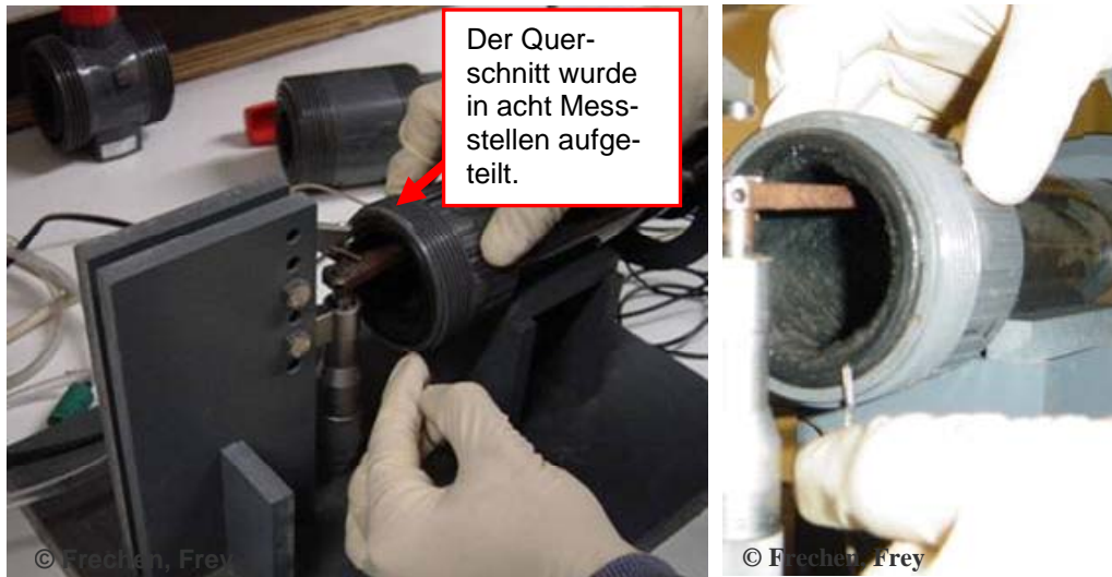
Abb.3.11: Messung der Sielhautdicke mit Hilfe einer Mikrometerschraube
