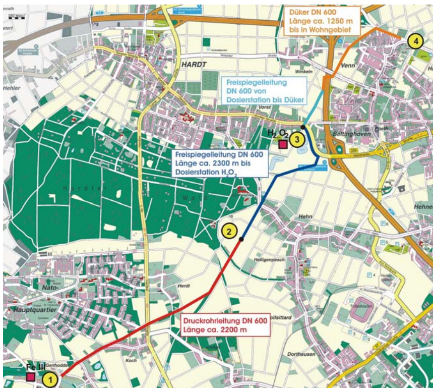
Abb. 8.1: Messschächte an der Kanal-Teststrecke Mönchengladbach-Genhodder (Quelle Kartenhintergrund: STADT MÖNCHENGLADBACH, FACHBEREICH VERMESSUNG UND KATASTER, GEODATENZENTRUM)
