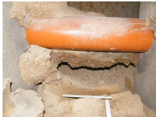
Bild 160 Acrylatgel-Injektionskörper hergestellt bei Grundwasserstufe II an Steinzeug- (links) und PVC-Rohranbindung DN 150 (rechts): Partielle Ablösung des Injektionskörpers von der Rohr- und Schachtwand
