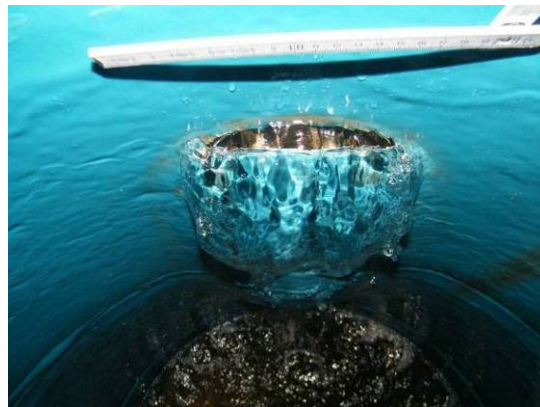
Bild 169 Polymere Beschichtungen in Bereichen, an denen der Verbund mit Trennmittel planmäßig geschwächt wurde: Blasenbildung mit fortschreitender Ablösung (links) und Aufreißen der Beschichtung (rechts)
