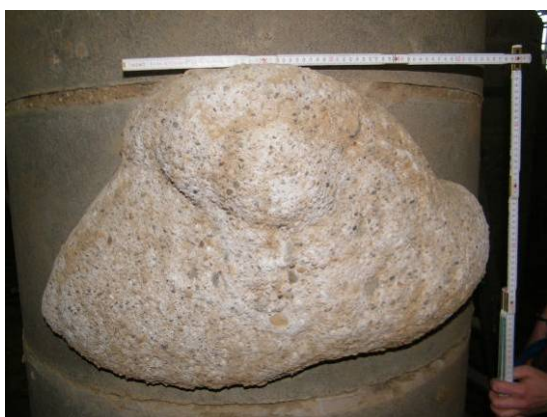
Bild 150 Zementleim-Injektionskörper an der sanierten Schadstelle FU 6 in der Ansicht (links) und in der Seitenansicht (rechts)
