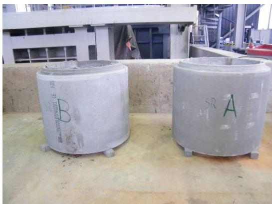
Bild 191 Schachtringe A und B (links) mit eingebaute Mörtelbeschichtungen; Beispiel für ein zu prüfendes Messfeld (rechts)
