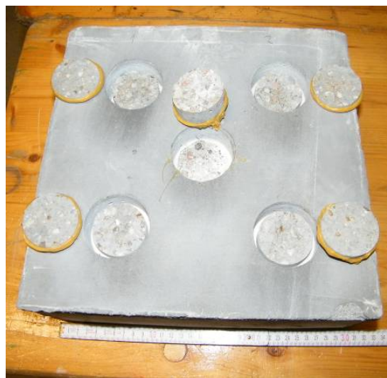
Bild 173 Probekörper für die Haftzugprüfung: Lage der Prüfstellen gemäß [51] (links) und Probekörper A1 nach der Prüfung (rechts)
