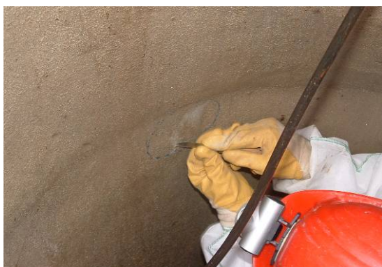
Bild 184 Untersuchung einer Hohlstelle auf Risse: Reinigung der Beschichtung mit einem Spachtel (links) und Nässen und Trocknen der Beschichtung (rechts)
