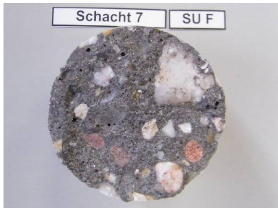
Bild 112: Bruchstelle exemplarisch für ein vollständiges Versagen im Betonuntergrund
