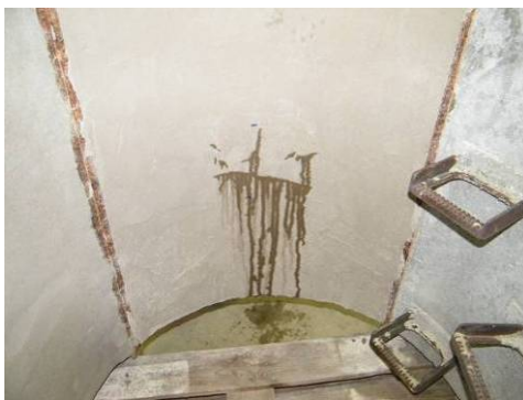
Bild 180 Wassereintritt bei 0,3 bar Außenwasserdruck: Probekörper H1 (links) und Probekörper H4 (rechts)
