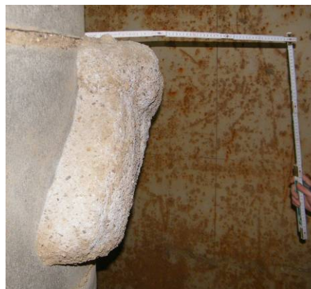
Bild 150 Zementleim-Injektionskörper an der sanierten Schadstelle FU 6 in der Ansicht (links) und in der Seitenansicht (rechts)
