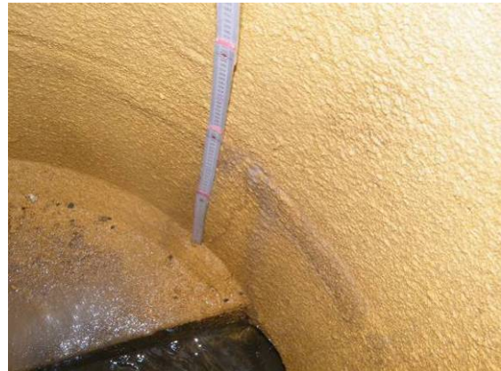
Bild 110 Polyfill-Beschichtung unter Grundwassereinwirkung GW II - Langzeit: Wassereindrang im Bereich einer Hohlstelle aus planmäßiger Verbundschwächung durch Trennmittel FU 2 (links), geringfügiger Wassereindrang im Bereich einer vorgeschädigten, reprofilierten Schachtringfuge SF 1 (rechts)
