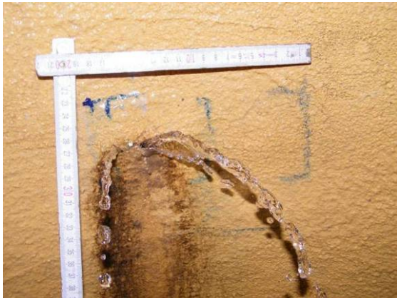
Bild 110 Polyfill-Beschichtung unter Grundwassereinwirkung GW II - Langzeit: Wassereindrang im Bereich einer Hohlstelle aus planmäßiger Verbundschwächung durch Trennmittel FU 2 (links), geringfügiger Wassereindrang im Bereich einer vorgeschädigten, reprofilierten Schachtringfuge SF 1 (rechts)
