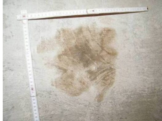
Bild 166 Dunkle Stellen am Mörtel mit Kristallbildner: größere Ausdehnung sowie dunklere Verfärbung zu Beginn der Untersuchungen (links) und geringere Ausdehnung und farblich hellere Ausprägung nach 13 Wochen (rechts)
