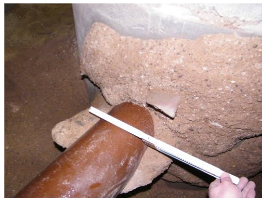
Bild 155 Polyurethan-Injektionskörper hergestellt bei Grundwasserstufe II an einem PVC-Rohr DN 150 (links) und Steinzeugrohr DN 150 (rechts)
