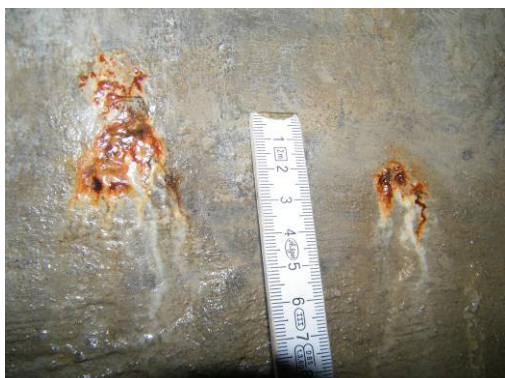
Bild 164 In Schächte eingedrungenes, weiches Injektionsmaterial aus Polyurethan (links) und Acrylat (rechts) entnommen für umwelthygienische Untersuchungen
