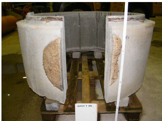
Bild 134 Schnitt durch Betonfertigteiltring mit Polyurethan-Injektionskörper einer abgedichteten Fehlstelle FU 6 (links), Seitenansicht von Schachtring und Injektionskörper mit Injektionsmittel in der Schadstelle (rechts)
