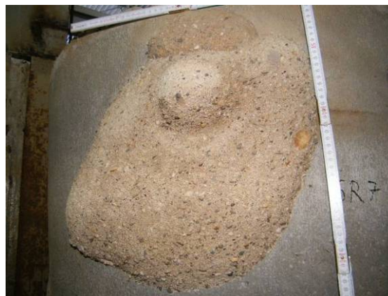
Bild 133 Polyurethan-Injektionskörper einer abgedichteten Fehlstelle FU 6 (links) und LS 7 (rechts)
