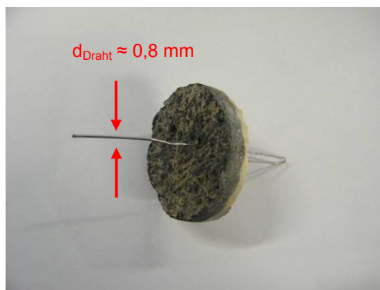
Bild 91 Wassereindrang mit Schmutzfließspuren an allen Schachtringfugen (links), Materialprobe aus einem Bereich mit einer Undichtigkeit - fehlendes Material mit einem Durchmesser von ca. 0,8 mm (rechts)
