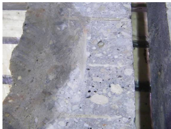
Bild 134 Schnitt durch Betonfertigteiltring mit Polyurethan-Injektionskörper einer abgedichteten Fehlstelle FU 6 (links), Seitenansicht von Schachtring und Injektionskörper mit Injektionsmittel in der Schadstelle (rechts)
