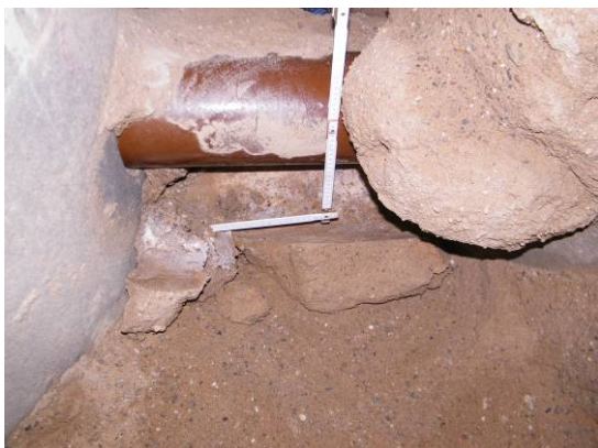
Bild 160 Acrylatgel-Injektionskörper hergestellt bei Grundwasserstufe II an Steinzeug- (links) und PVC-Rohranbindung DN 150 (rechts): Partielle Ablösung des Injektionskörpers von der Rohr- und Schachtwand
