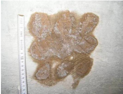
Bild 166 Dunkle Stellen am Mörtel mit Kristallbildner: größere Ausdehnung sowie dunklere Verfärbung zu Beginn der Untersuchungen (links) und geringere Ausdehnung und farblich hellere Ausprägung nach 13 Wochen (rechts)
