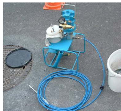
Bild 21 Injektionsverfahren bei einem Einsatz im Sohlbereich: Packer in der Schachtwand und eingetretenes Injektionsgut (links) und Beispiel für eine Injektionspumpe (rechts)
