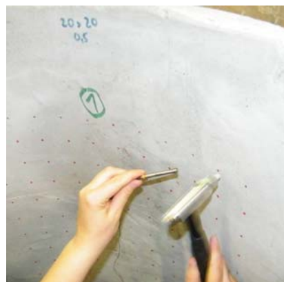
Bild 191 Schachtringe A und B (links) mit eingebaute Mörtelbeschichtungen; Beispiel für ein zu prüfendes Messfeld (rechts)
