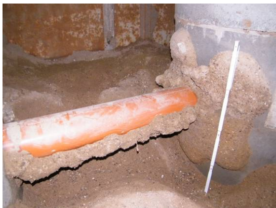
Bild 155 Polyurethan-Injektionskörper hergestellt bei Grundwasserstufe II an einem PVC-Rohr DN 150 (links) und Steinzeugrohr DN 150 (rechts)
