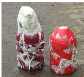
Abb. 155: Beschichtete Schaumstoffmolche mit aufgenommenem Fett
