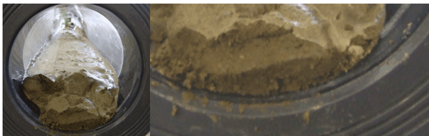
Abb. 134: Beispiel für eingebrachte Ablagerung aus Flüssigboden
