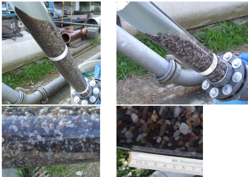
Abb. 170: Sandrückstände bei v = 0,5 \text{ m/s} (li) und 0,6 \text{ m/s} (re)
