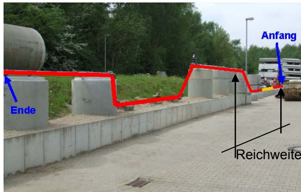
Abb. 165: Reichweite des Spülschlauches in der IKT-Teststrecke
