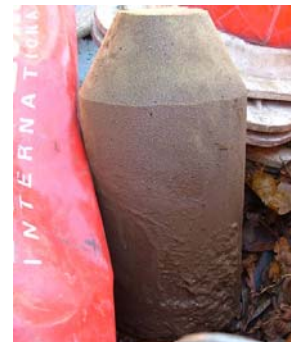
Abb. 82: Schaumstoffmolch nach Reinigung
