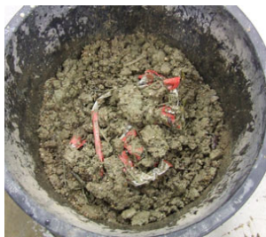
Abb. 136: Beispiel für eingebrachtes Gemisch aus Kies, Sand, Faserstoffen, Bentonit und Laub
