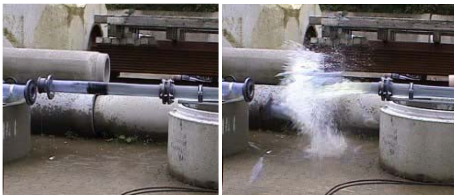
Abb. 163: Zerplatzendes Rohrstück bei Drucksteigerung bis 12 bar (oberhalb des Nenndrucks der Leitung), Rohrstück mit 20 % Verformung
