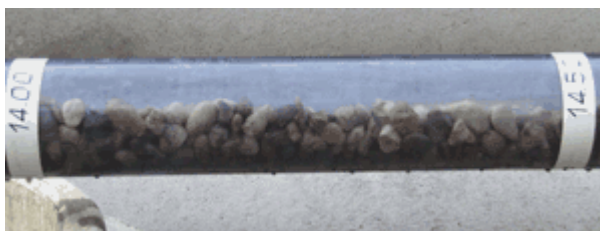
Abb. 131: Beispiele für eingebrachte Ablagerungen aus Kies
