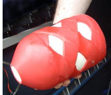
Abb. 58: Molchtyp II aus PE-Schaum mit PUR-Streifen
