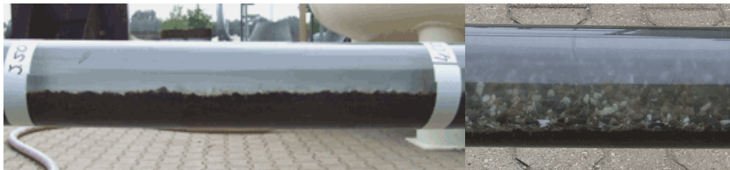
Abb. 130: Beispiele für Ablagerungen aus Kiessand
