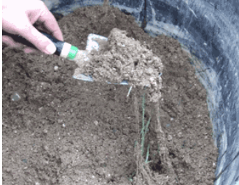
Abb. 137: Beispiel für eingebrachtes Gemisch aus Sand und Faserstoffen
