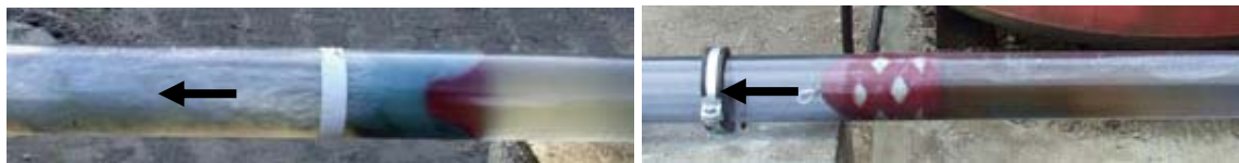
Abb. 153: Umströmter Schaumstoffmolch (li) und nahezu abdichtender beschichteter Molch (re)
