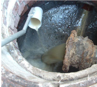
Abb. 64: Probennahme am Auslauf der Druckleitung
