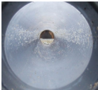
Abb. 167: Leichte Rückstände feiner Fettflocken
