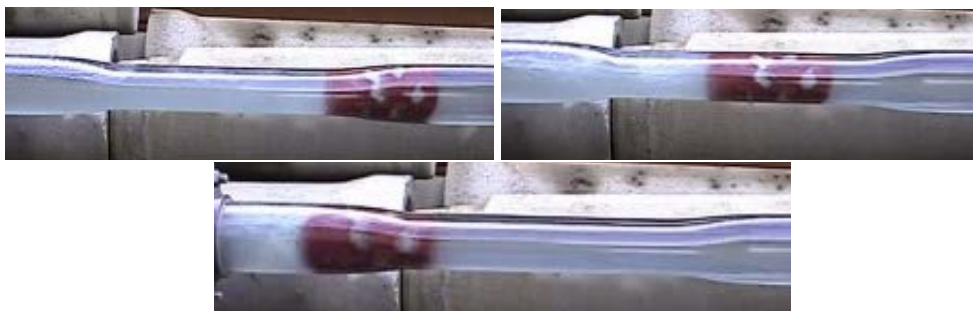
Abb. 162: Überwinden der Verformung von 40 %, Schaumstoffmolch
