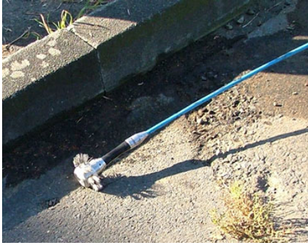
Abb. 28: Schiebekamera mit starrem Kopf
