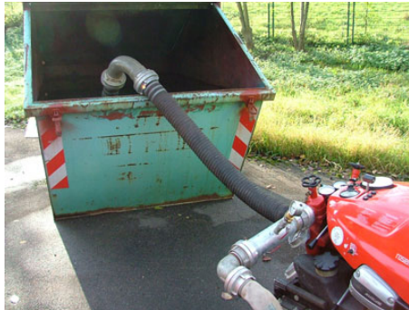
Abb. 73: Feuerweerpumpe und Container als Wasservorratsbehälter
