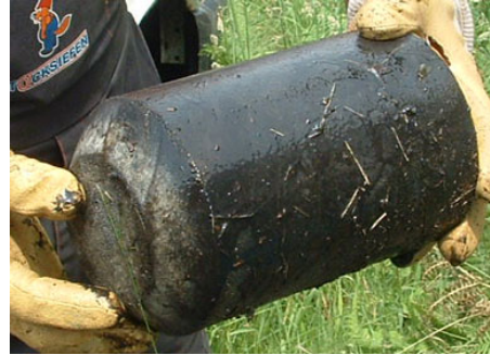
Abb. 59: Molchtyp III aus PE-Schaum mit PUR-Ummantelung
