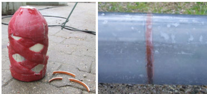
Abb. 159: Gelöste „Schweißnaht“ mit leicht beschädigtem Molch (Molch 7)
