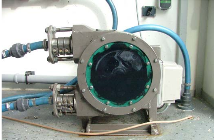
Bild 8: Schlauchpumpe zur Entnahme von Abwasserproben
