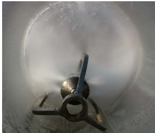
Bild 78: Optische Prüfung des Strahlbildes
