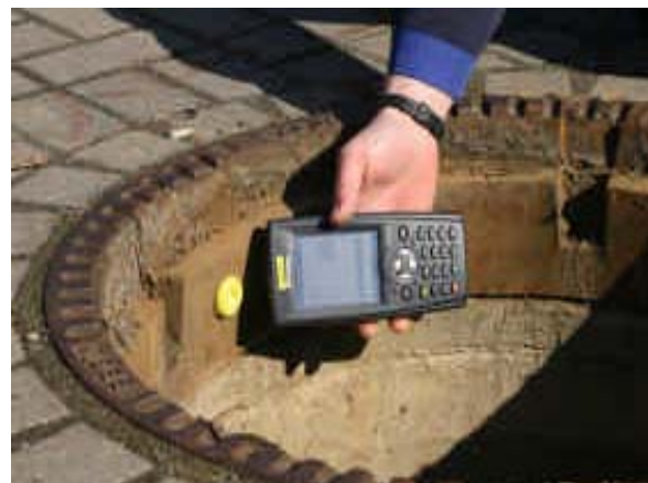
Bild 23: Einlesen eines Transponders mit einem integrierten Lesegerät (TECTUS GmbH)
