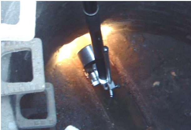
Bild 44: In-Situ-Einsatz verschiedener Inspektionsmethoden zur Ablagerungserkennung. A: Inspektion mit Fahrwagenkameras. B und C: Inspektion mit Schachtkamera. D: Inspektion mit Kanalspiegel.
