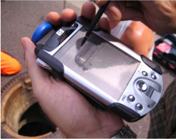
Bild 88: Über ein Menü geführte Protokollierung der Betriebsdaten
