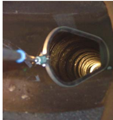
Bild 44: In-Situ-Einsatz verschiedener Inspektionsmethoden zur Ablagerungserkennung. A: Inspektion mit Fahrwagenkameras. B und C: Inspektion mit Schachtkamera. D: Inspektion mit Kanalspiegel.
