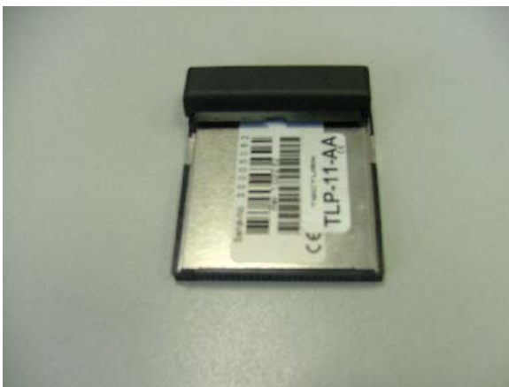
Bild 22: Lesegerät mit interner Antenne
