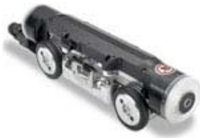
Bild 8: Panoramo-Kugelscanner der Firma Ibak
