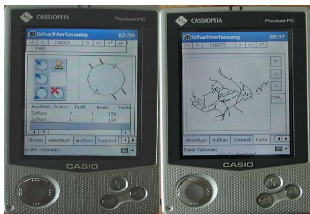
Bild11: MDE-Gerät von Casio mit proKan CE-Software (Bosseler und Puhl, 2006)
