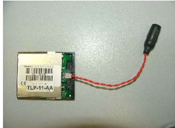
Bild 21: Lesegerät mit externer Antenne
