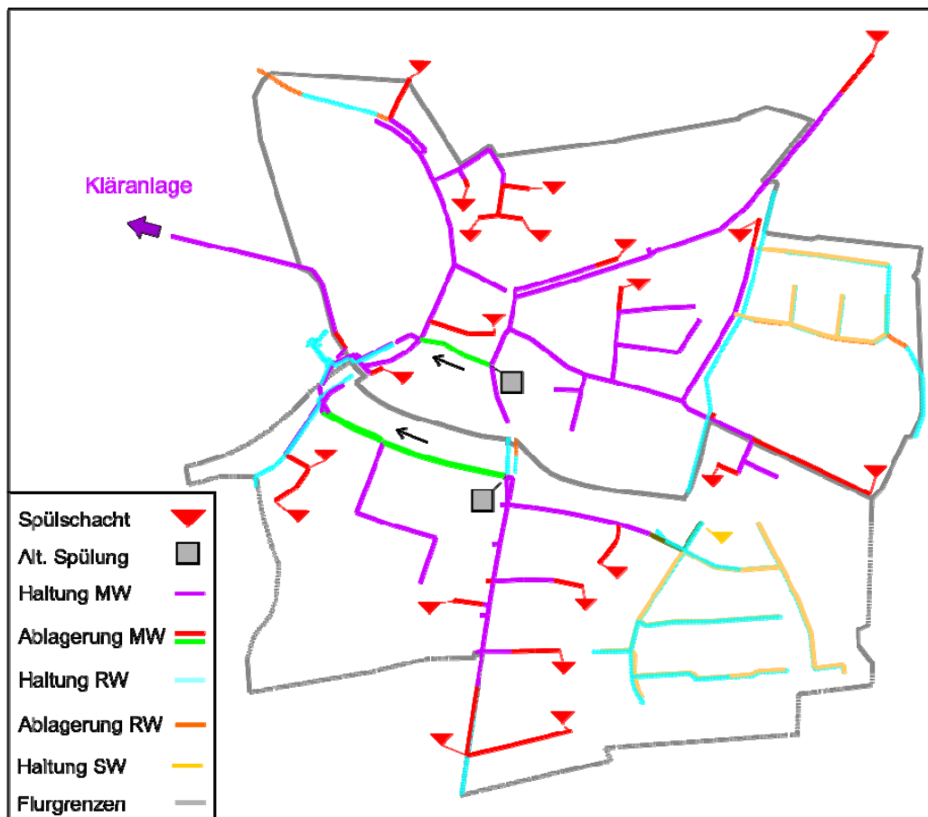
Bild 5.1: Darstellung der ablagerungskritischen Bereiche im Entwässerungssystem von Hoetmar sowie die Positionierung von Spülschächten in Anfangshaltungen
