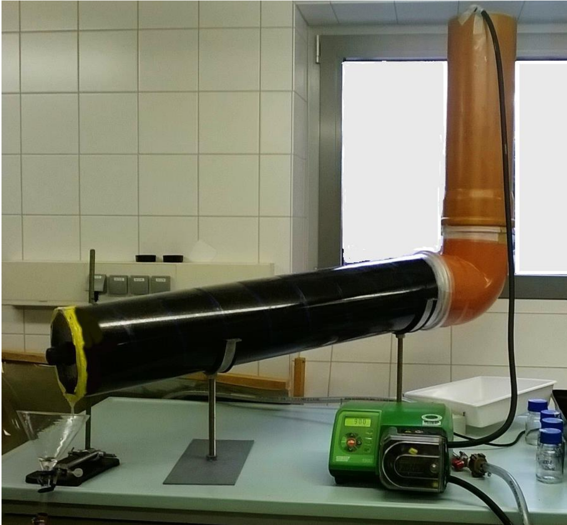
Abbildung 8: Versuchsaufbau des Laborversuchs mit dem neuen Drainagefilter
