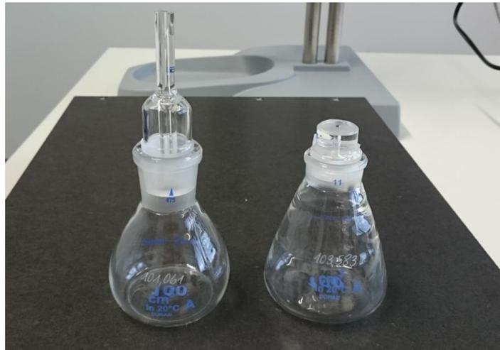
Abbildung 93: Pyknometer nach GAY LUSSAC (links) und nach HUBBARD (rechts)
