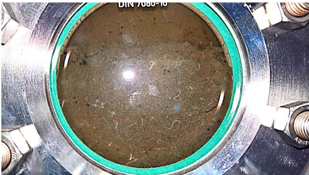
Abbildung 4.45: Schlammsedimentation während der Belüftung mit 2,8 m Einblastiefe. Aufgenommen durch das unterste Schauglas der Technikumsanlage.
