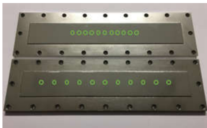
Abbildung 3.3: Lochplatten mit unterschiedlichen Lochabständen. Lochöffnungen durch grüne Kreise markiert.
