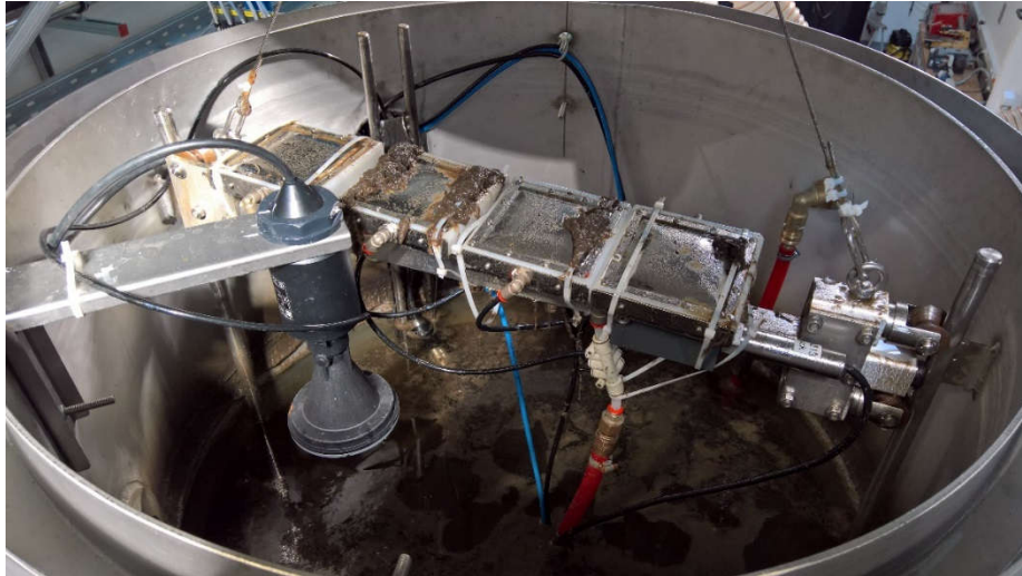
Abbildung 4.32: Edelstahlbelüfter auf Schlitten nach komplettem Durchlauf der Sauerstoffeintragsversuche.
